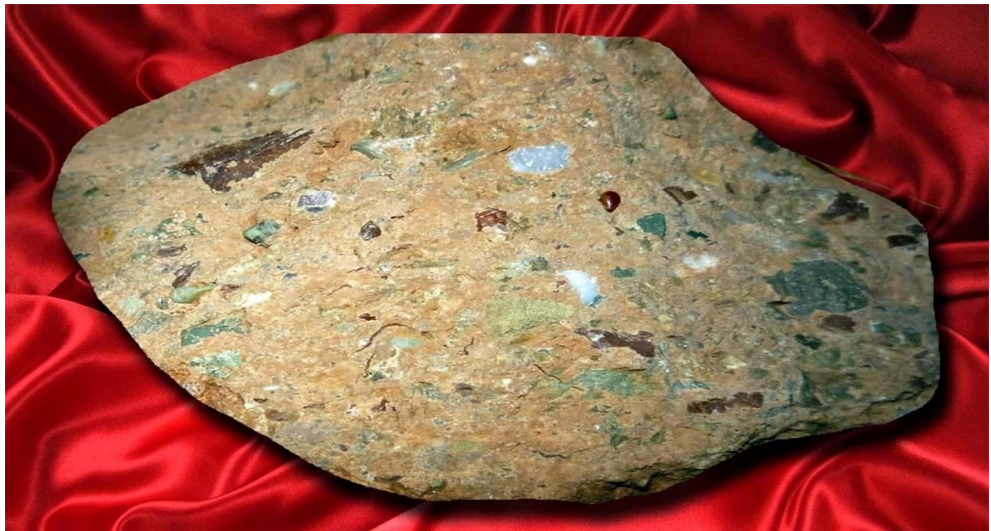
Şekil 3.67: Özel Karışımlı Harç (Horasan) örneği [Ceylal, 2023].
