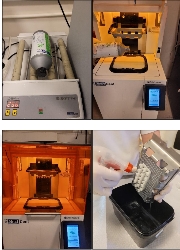
Resim 3.12. Uzun süreli geçici restorasyon reçinesinin karıştırılması, 3BY polimer haznesine tatbiki, baskının sonlanmasıyla beraber üretim tablasının asansörle yükselmesi, etil alkolle kronların temizlenmesi.
