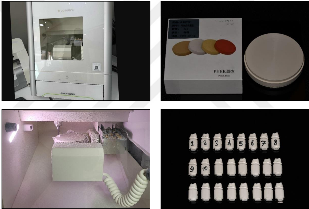
Resim 3.5. PEEK alt yapıların üretiminde kullanılan kazıma cihazı, çalışmada kullanılan PEEK disk, PEEK diskin frezelenmesi, kazıma sonucu elde edilen PEEK alt yapılar.
