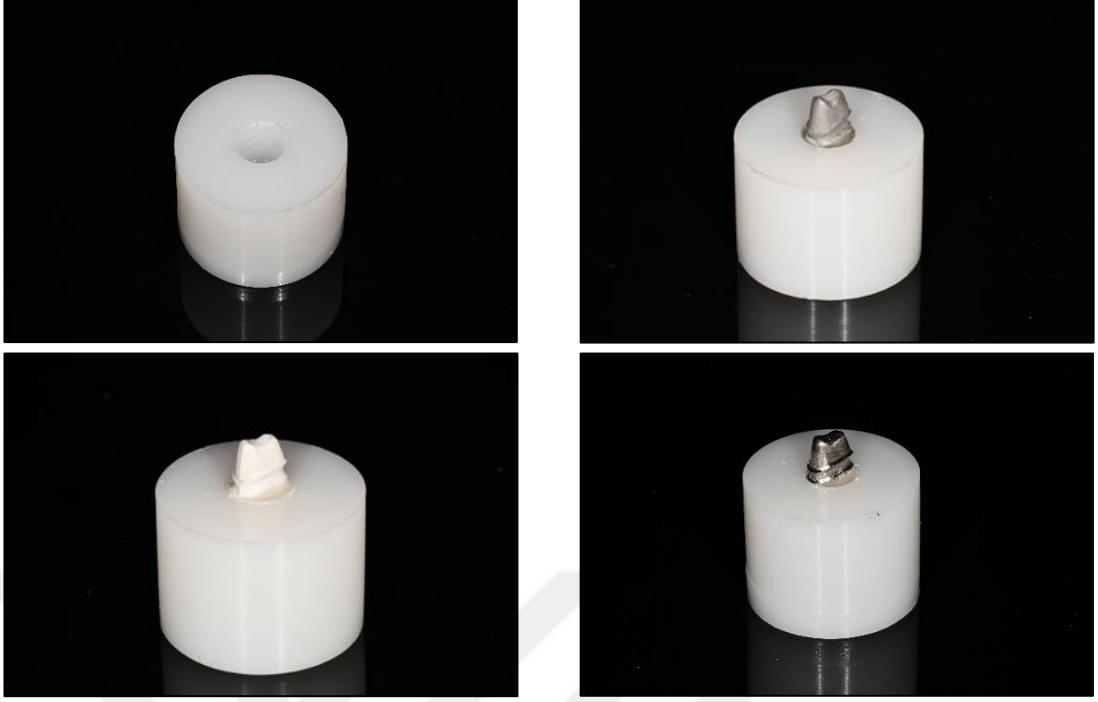
Resim 3.19. Alt yapı örneklerinin içerisine gömüldüğü polimer kalıp ve yerleştirilmiş alt yapı örnekleri.
