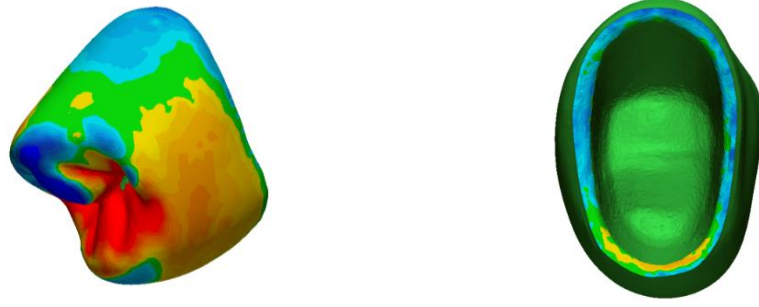
Resim 3.17. Kron restorasyonun doğruluk inceleme programında analiz edilmesi ve deviasyon renk haritalarının oluşturulması.
