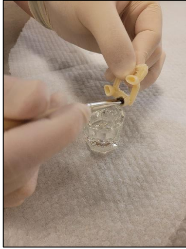
Resim 3.9. Daimî restorasyon reçinesinin karıştırılması, 3BY polimer haznesine tatbiki, baskının sonlanmasıyla beraber üretim tablasının asansörle yükselmesi, etil alkolle kronların temizlenmesi.
