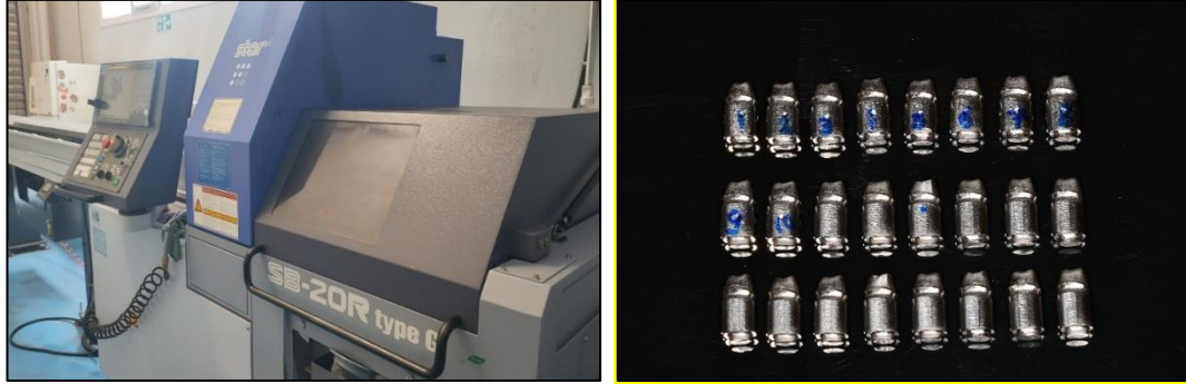
Resim 3.6. Titanyum alt yapıların üretiminde kullanılan CNC cihazı ve üretilmiş titanyum alt yapılar.
