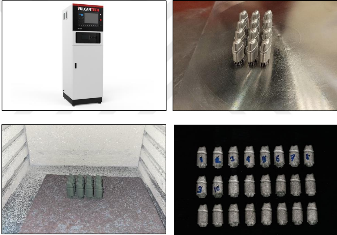
Resim 3.4. CoCr alt yapı grubunun üretildiği DMLS cihazı ve CoCr alt yapı örneklerin sinterleme fırınında ısıtılma işlemi tabii tutulmadan önce üretim tablası üzerindeki görüntüsü, tüm CoCr alt yapı örneklerin görüntüsü.
