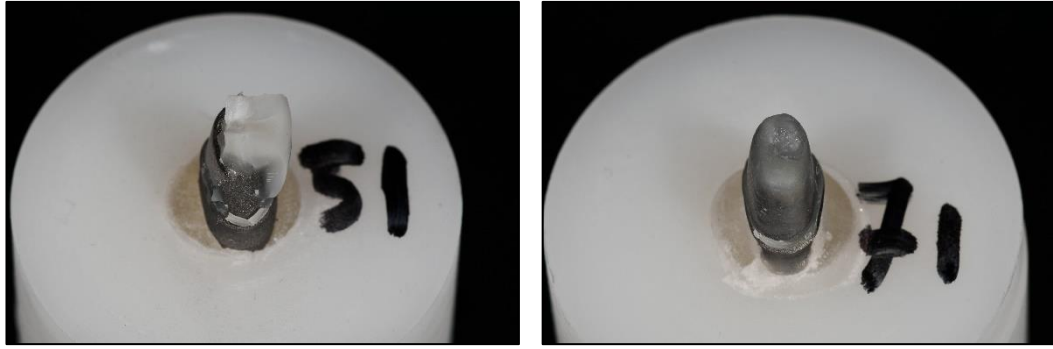
Resim 4.7. Tamir edilebilir küçük çatlak veya kırık (Tip 1), kronun yarısından daha az madde kaybı görülen (Tip 2), kronun yarısından fazla madde kaybı görülen (Tip 3) ve tam kron kırığı görülen (Tip 4), tamir edilemez (katastrofik) kırık tiplerine ait örnekler
