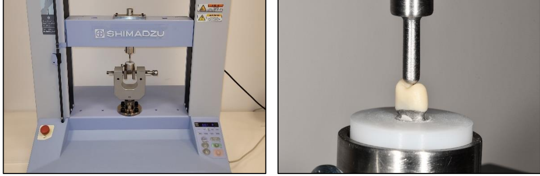
Resim 3.24. Universal kırma testi cihazı düzeneği ve düzeneğe yerleştirilen örnek.
