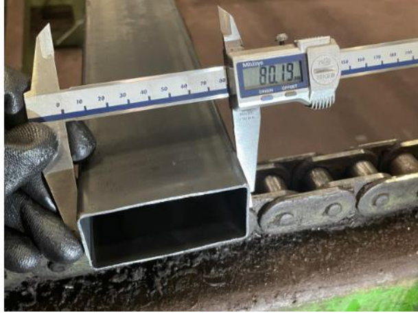
Şekil B.15: Profil denemesi 2 uzun kenar kumpas ölçümü.
