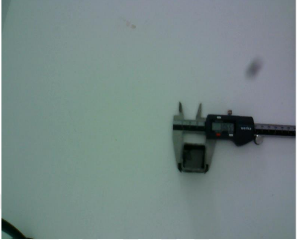
Şekil 6.5: Kare profil genişlik kumpas ölçümü.
