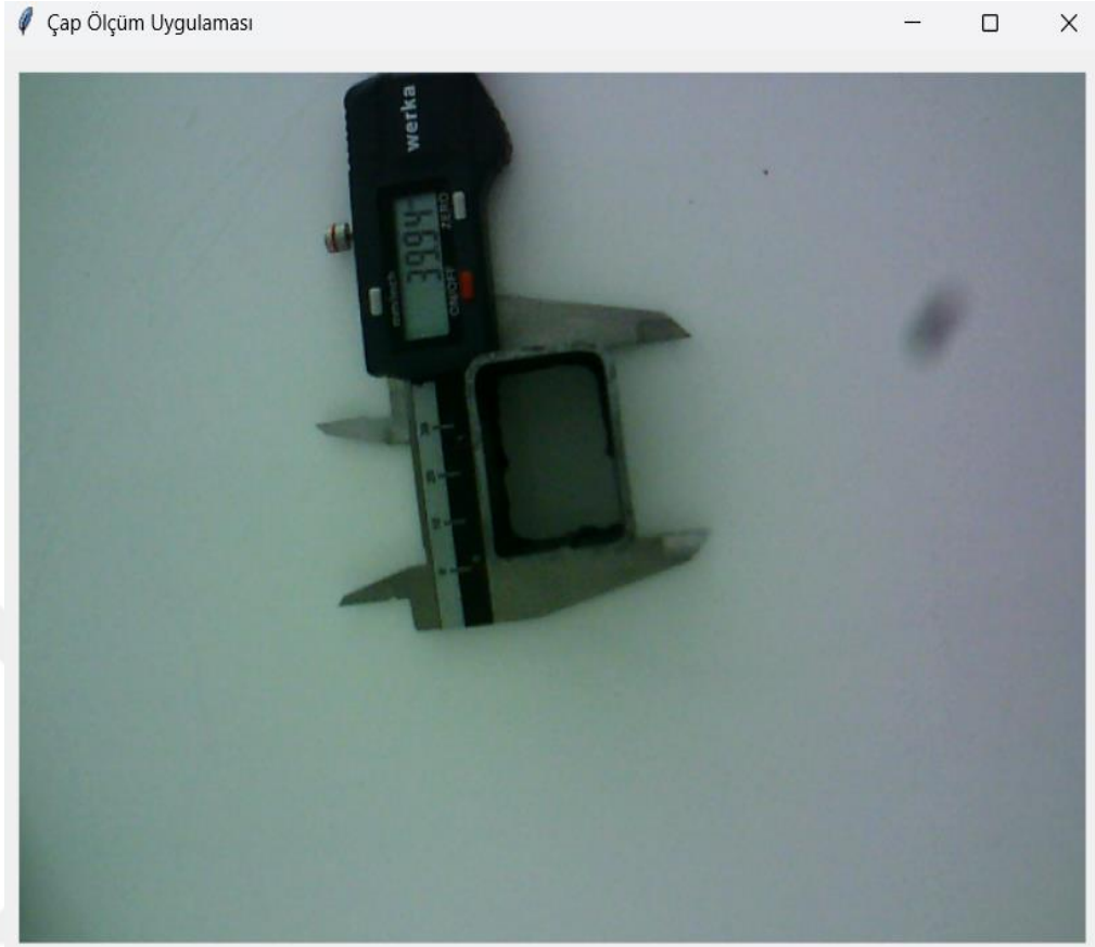
Şekil 6.1: Profil uzunluğu kumpas ölçüsü.
