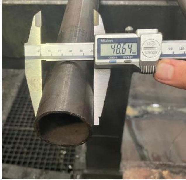
Şekil B.9: Boru denemesi 4 kumpas ölçümü.
