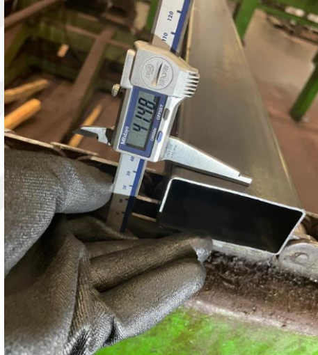
Şekil B.16: Profil denemesi 2 kısa kenar kumpas ölçümü.
