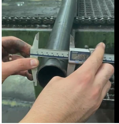
Şekil B.5: Boru denemesi 2 kumpas ölçümü.
