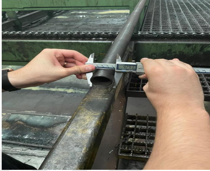
Şekil B.1: Boru denemesi1 kumpas ölçümü.
