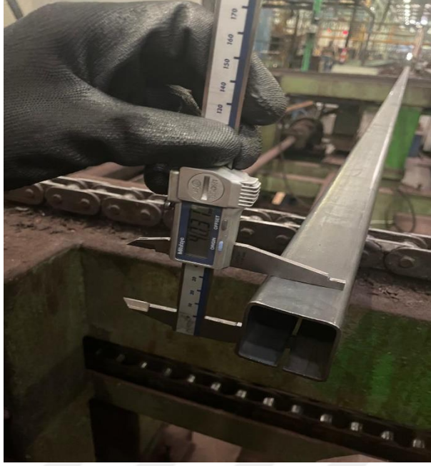
Şekil B.11: Profil denemesi 1 kısa kenar kumpas ölçümü.
