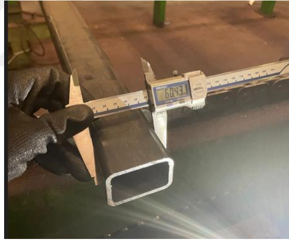
Şekil B.12: Profil denemesi 1 uzun kenar kumpas ölçümü.
