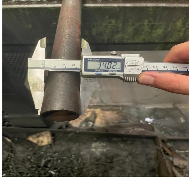
Şekil B.7: Boru denemesi 3 kumpas ölçümü.
