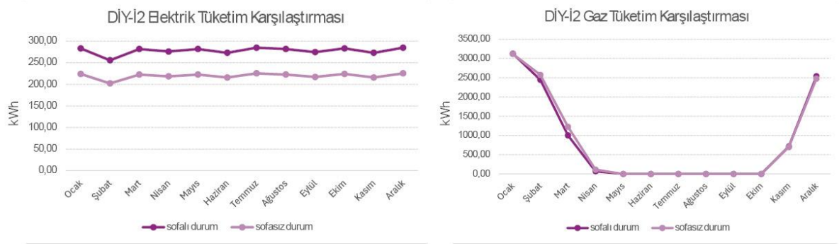
Şekil 4.87: DİY-İ2 evi sofalı durum ve sofasız duruma ait aylık (Ocak-Aralık, 12 ay) yakıt (elektrik, gaz) tüketim analiz sonuçlarının karşılaştırma grafiği.
