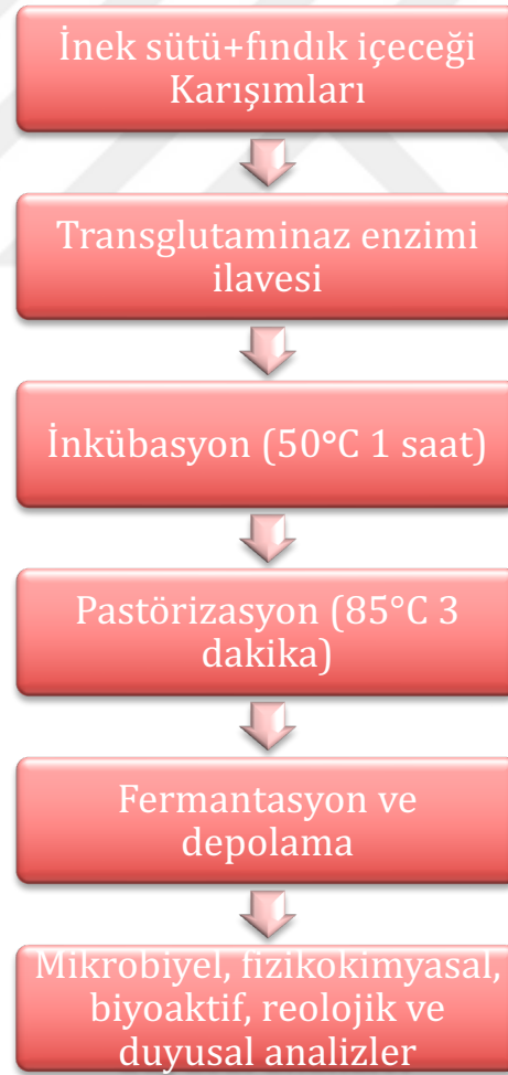
Şekil 3.3. Kefir üretim akış şeması
