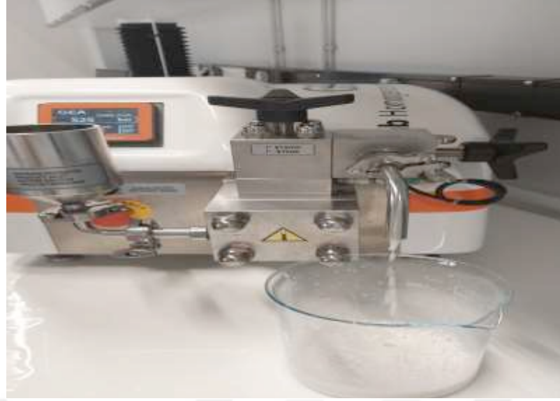
Şekil 3.2. Fındık içeceklerinin yüksek basınç homojenizatör cihazından geçirilmesi
