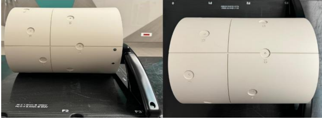
Resim 5. Varian Ethos lineer hızlandırıcı cihazında MPC ölçümünde kullanılan Isocal fantom
