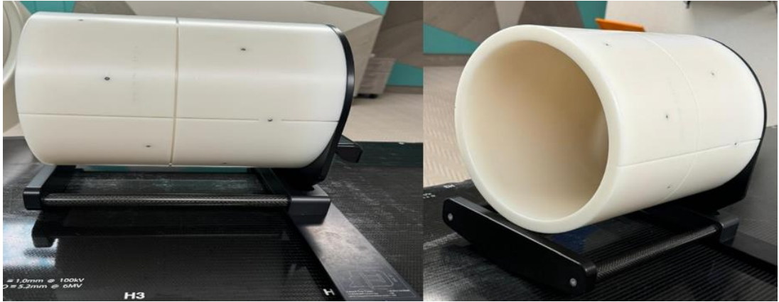
Resim 4. Varian Truebeam lineer hızlandırıcı cihazında MPC ölçümünde kullanılan Isocal fantom
