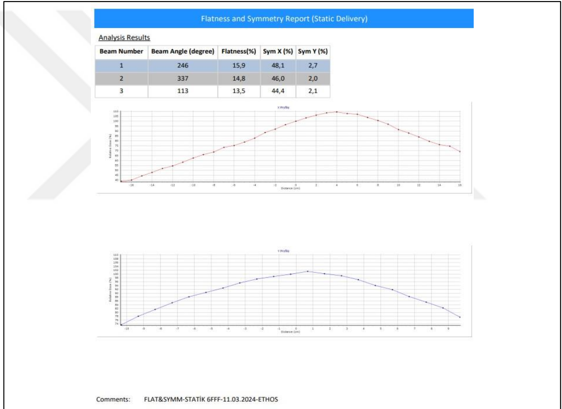
Şekil 6. 6 FFF MV enerjide statik teknikte düzgünlük ve simetri testinin 6.ölçümden elde edilen rapor görüntüsü
