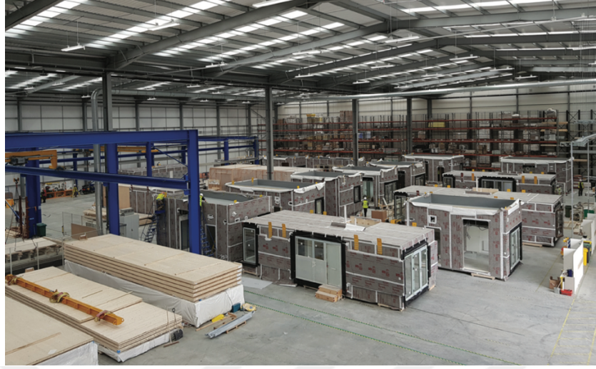
Şekil 1.18: Hacimsel ahşap birimlerin dış membranlar ve pencerelerle işlendiğinin görüldüğü fabrika ortamı (WTA, 2023)
