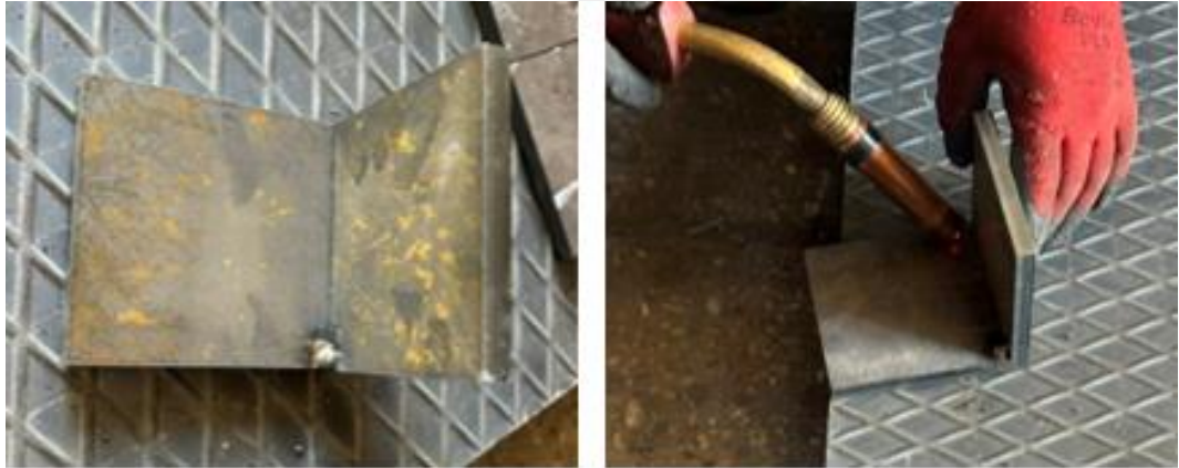
Şekil 2.6. İki malzemenin birbirine puntalama işleminin görüntüsü.
