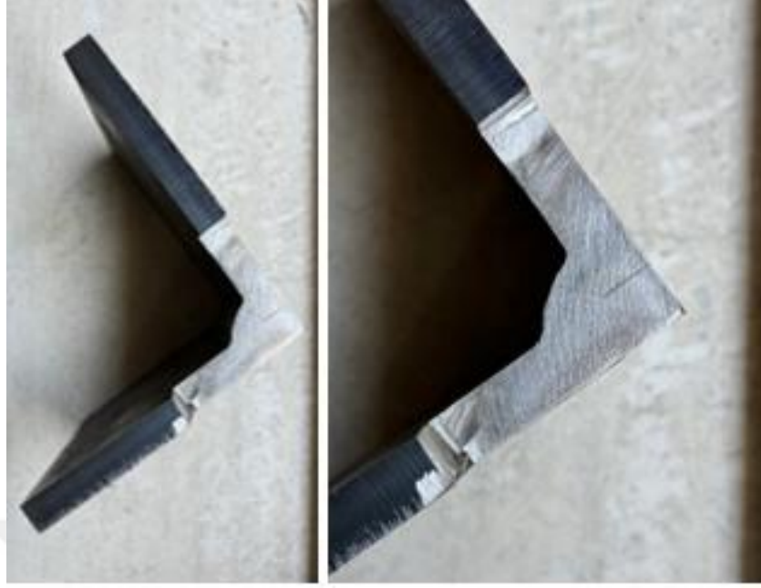
Şekil 2.29. S960 malzeme - izolasyon örtüsü ile yavaş soğutma yöntemi uygulanan test parçasının kaynak bölgesine ait görüntüsü.
