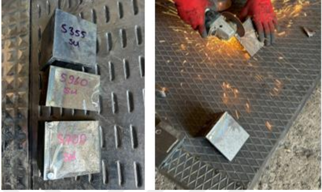
Şekil 2.11. Alın soğutma yöntemlerinin işaretlenmesi ve kesit alma işleminin uygulanması
