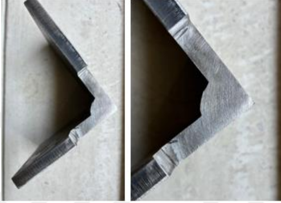
Şekil 2.19. S700 malzeme - su ile hızlı soğutma yöntemi uygulanan test parçası.
