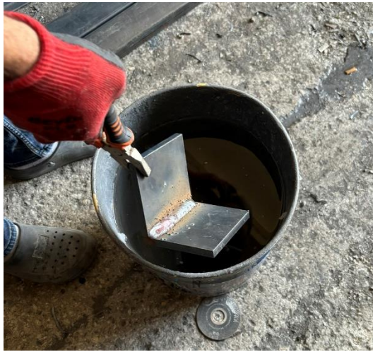
Şekil 2.8. Su ile hızlı soğutma yöntemi uygulaması.
