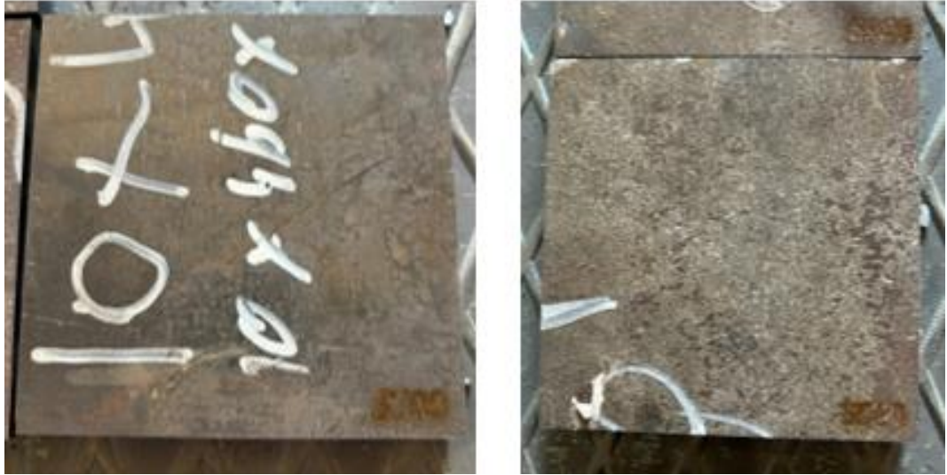
Şekil 2.3. Üzerine markalama işlemi yapılmış S700 ve S960 malzeme test plakası.
