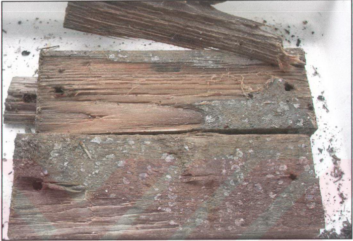
Şekil 3.19 Denizde bırakılmış Tanalith-C ile emprenyeli sarıçam öz odun panelleri.
