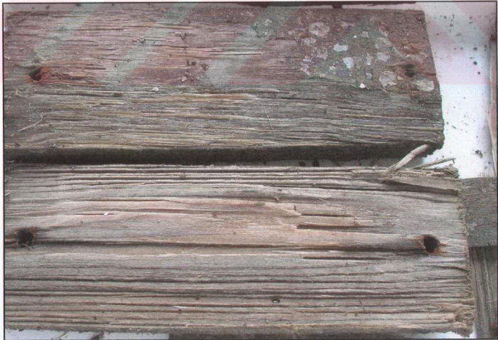
Şekil 3.20 Denizde bırakılmış Tanalith-C ile emprenyeli sarıçam diri odun panelleri.
