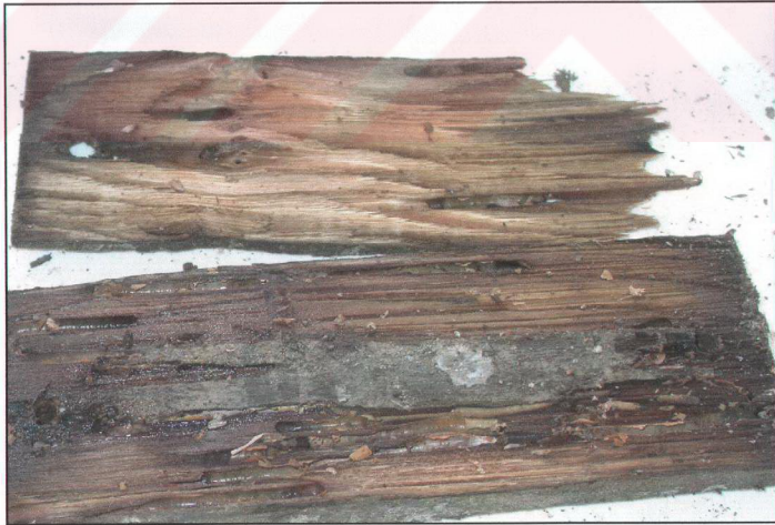
Şekil 3.22 Denizde bırakılmış Tanalith-C ile emprenyeli kestane öz odun paneli.
