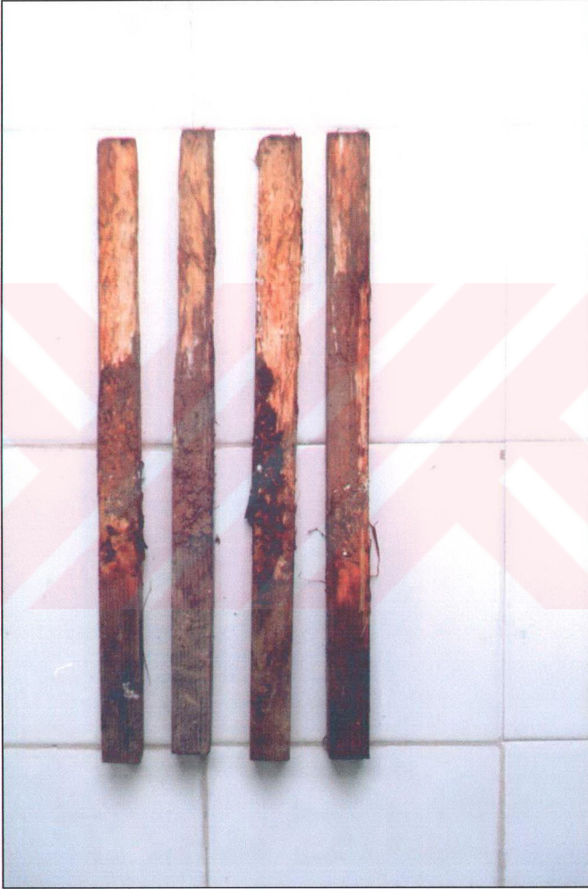
Şekil 3.14 Bir yıl süreyle arazide kalmış sarıçam kontrol diri odun örnekleri.
