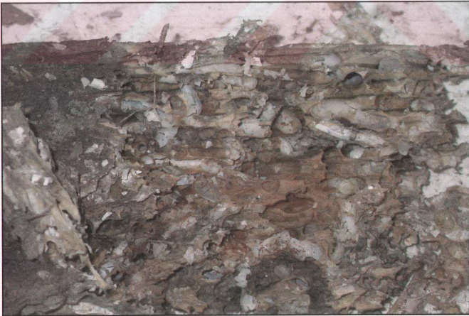
Şekil 3.18 Denizde bırakılmış sarıçam öz odun kontrol paneli.
