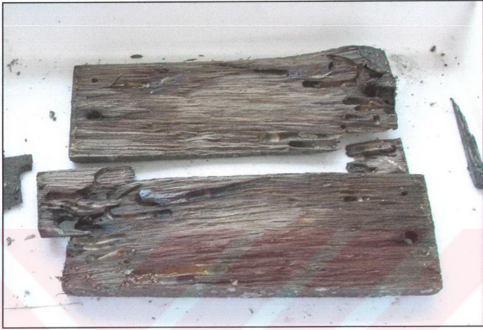
Şekil 3.21 Denizde bırakılmış Tanalith-C ile emprenyeli meşe diri odun paneli.
