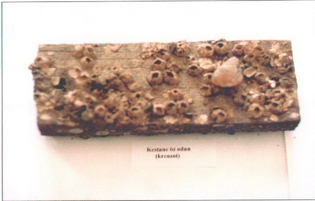
Şekil 3.17 Deniz testi yapılmış kreozot ile emprenyeli kestane öz odun.
