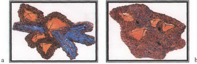
Şekil 7, a) Pekişmiş bünyede kil minerelleri ve özsüz hammaddeler. b) Pekişmiş bünyede kil minerelleri ve özsüz hammaddelerin genel görünümü. (AYTER, R. 2003)
