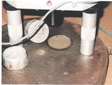
Şekil 3.27. Beton yapıştırıcısının dağılım yüzeyi
