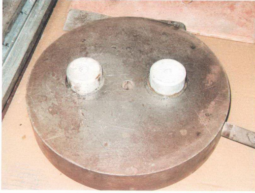
Şekil 3.26. Epoksi ve beton yapıştırıcısı ile çelik-standart alüminyum başlık birleşimi
