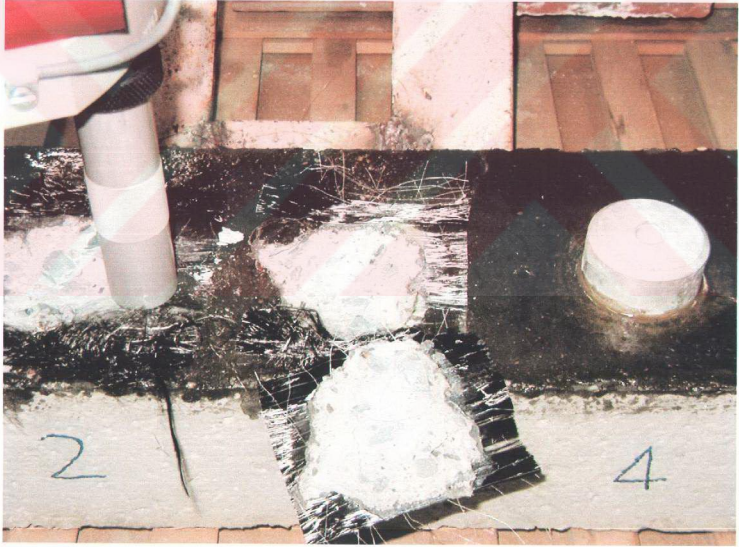
Şekil 3.28. Epoksi ile yapıştırılmış yüzey
