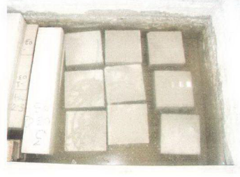
Şekil 2.10. Küp numuneler kür havuzunda
