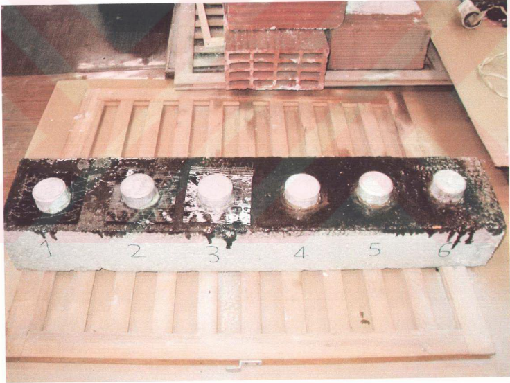
Şekil 3.25. Aynı beton yüzeye epoksi ve beton yapıştırıcısı uygulanması
