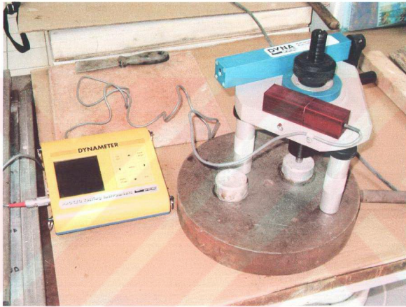
Şekil 2.8. Pull off tester deney aleti
