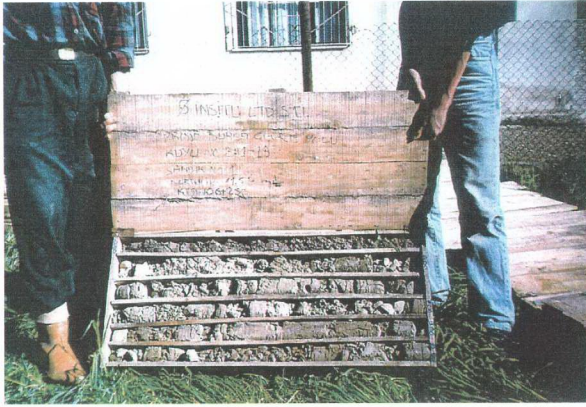
Şekil B-17. Km 106+250 sağ yarmada açılan BH 1/19 sondası 1 nolu karot sandığı.
