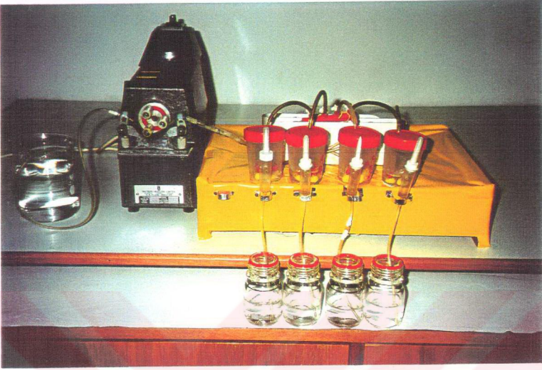
Resim: 2.2 Ağzı ortamını taklit etmek amacıyla hazırlanan deney düzeneği
