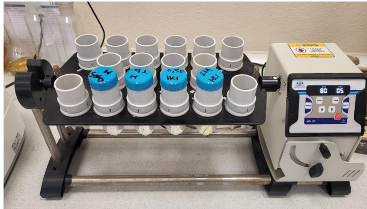
Şekil 4.10: Solvent ekstraksiyon deney düzeneği.
