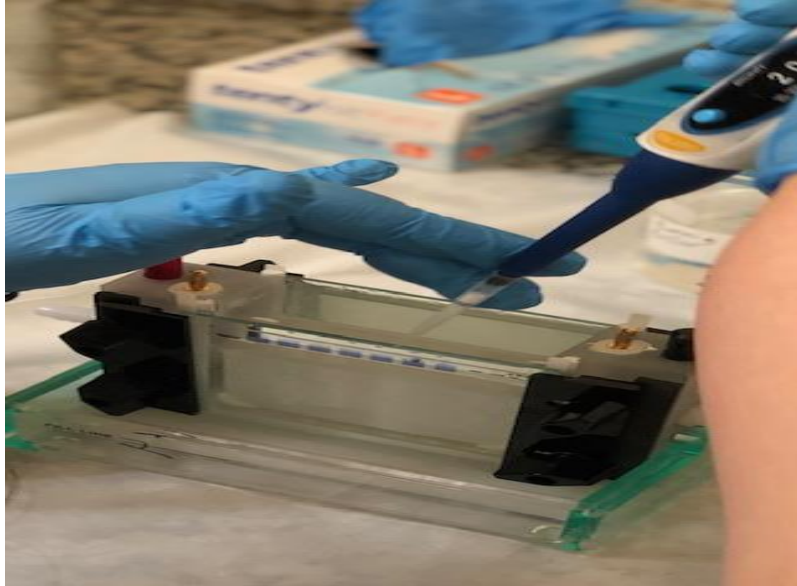
Resim 5. Elektroforez düzeneğine numunelerin yüklenmesi
