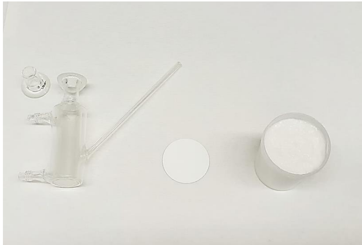
Şekil 3.1 Deney düzeneği Franz difüzyon hücresi, selüloz membran ve krem örneği
