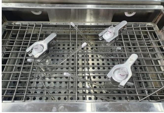
Şekil 3.2 Deney düzeneği sıcak su banyosu
