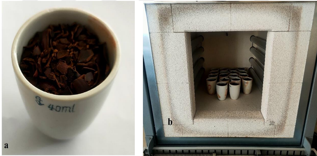
Şekil 2.4. Karbonizasyon Örnekleri (a), Kül Fırınına Yerleştirilen Örnekler (b).
