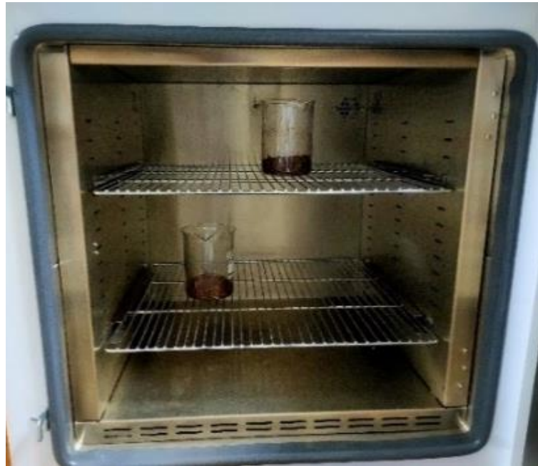
Şekil 2.3. Etüvde Kurutma İşlemi.
