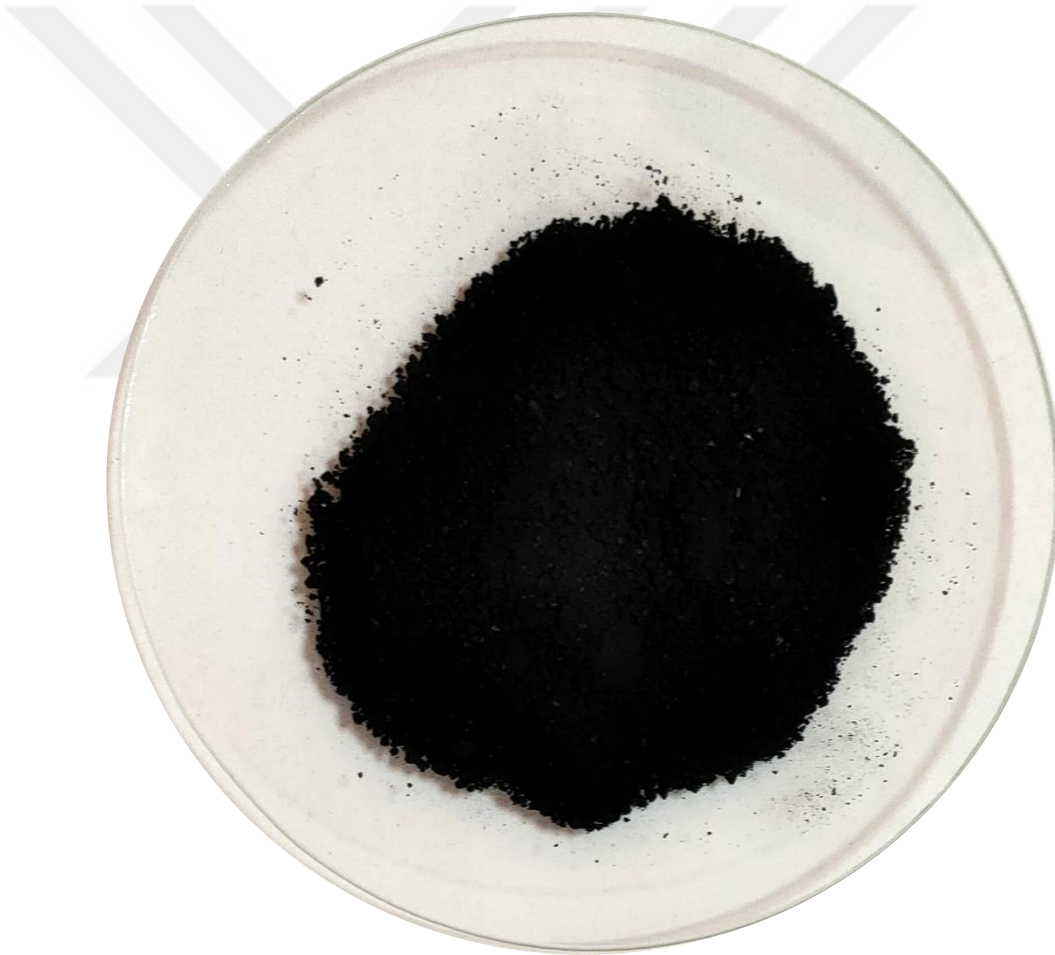
Şekil 3.1. Karbonizasyon Sonucu Elde Edilen Aktif Karbon.
