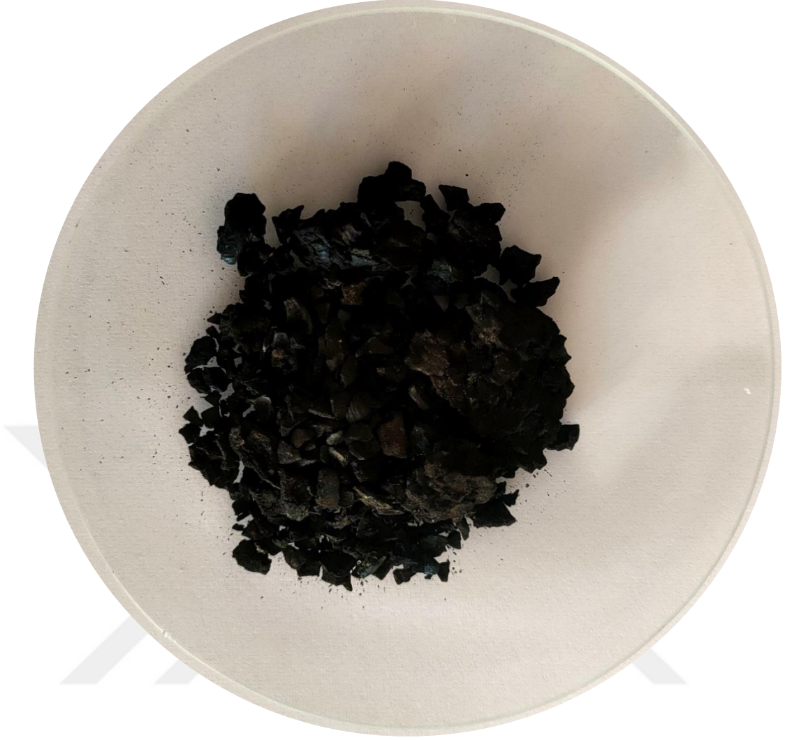
Şekil 2.5. Karbonizasyon Sonucu Elde Edilen Aktif Karbon.
