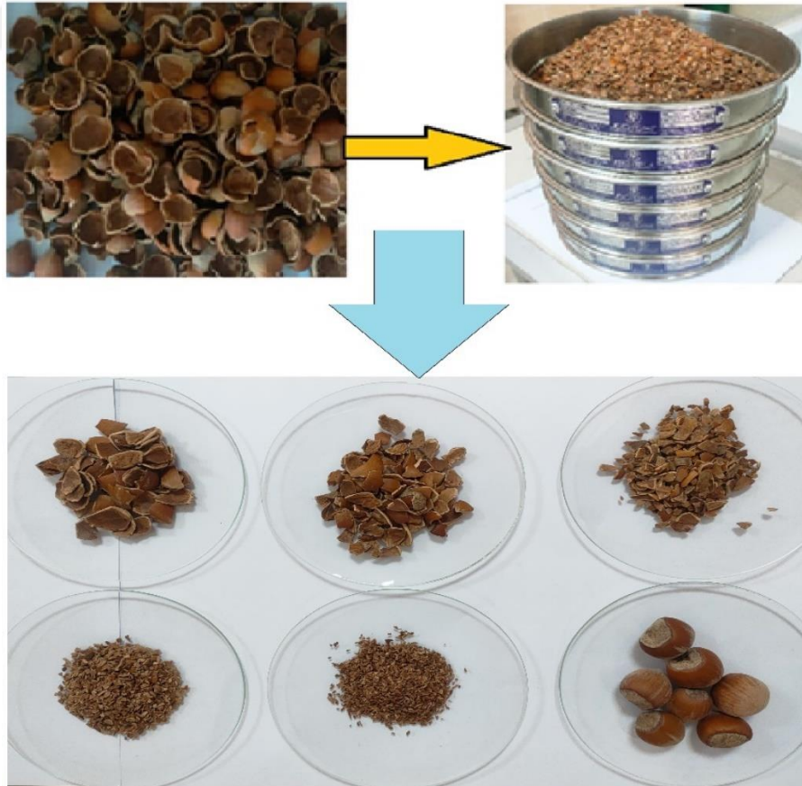
Şekil 2.1. Fındık Kabuklarının Boyut Küçültmesi
