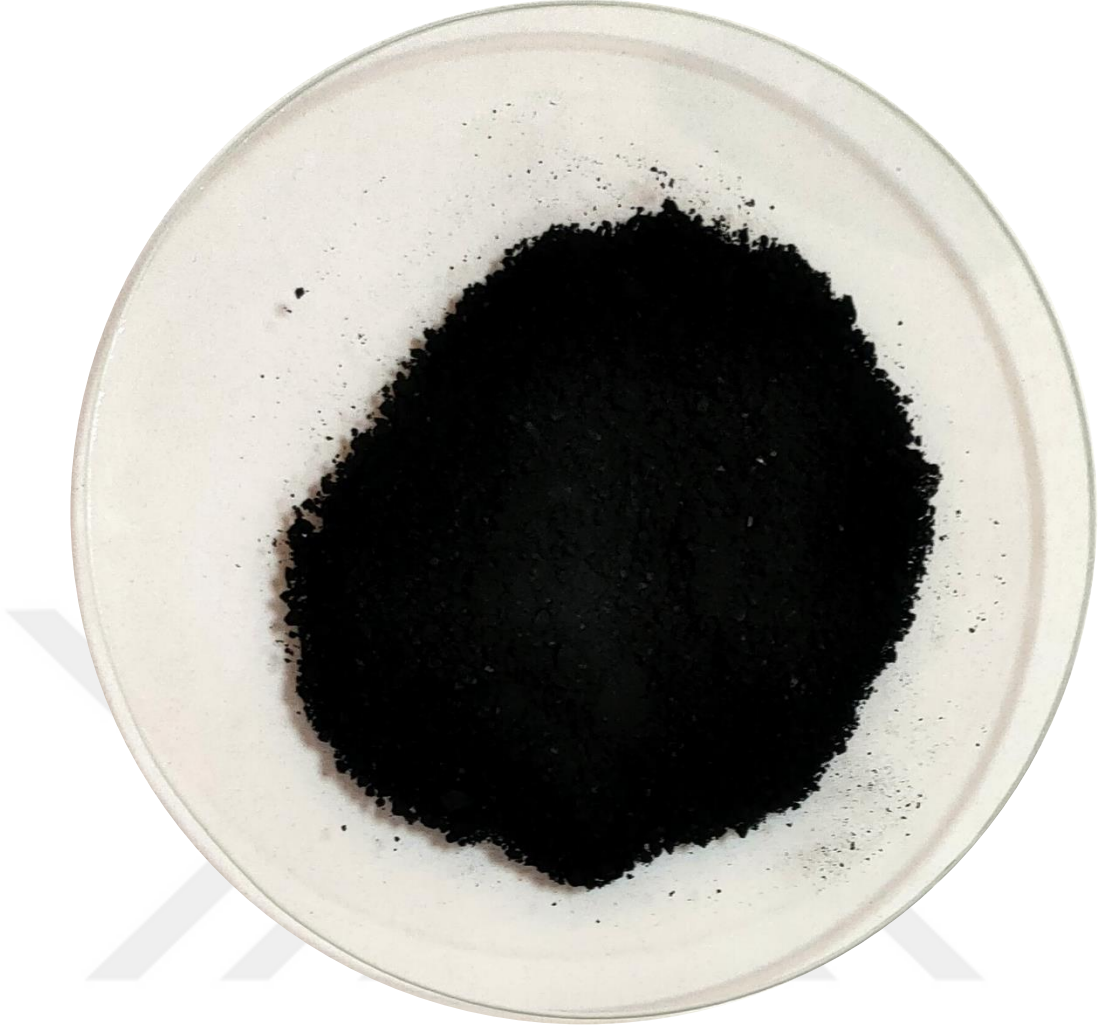
Şekil 2.6. BET Analiz Örneği İçin Boyutlandırılan Aktif Karbon
