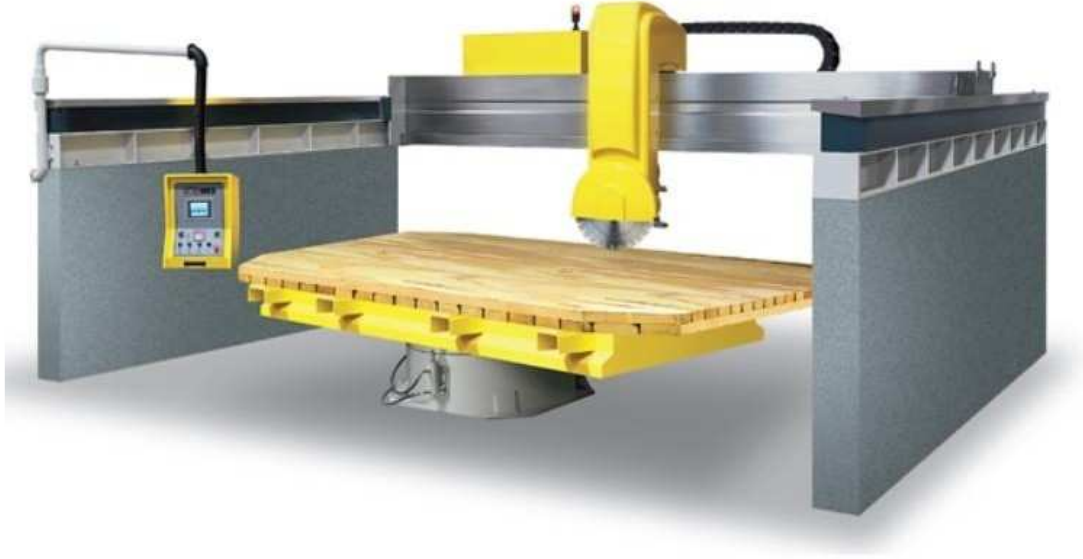
Şekil 4.4 : Köprü kesme makinesi (MKS, 2023)
