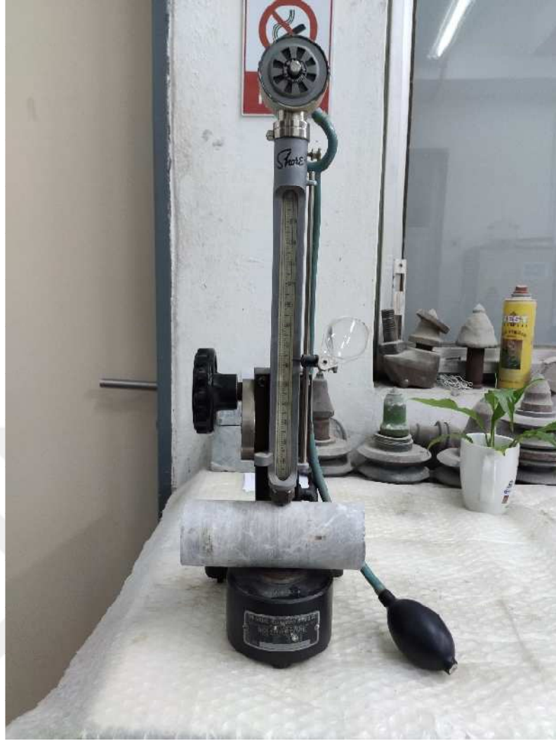
Şekil 7.9 : C-2 tip Shore Scleroscope deney aleti.
