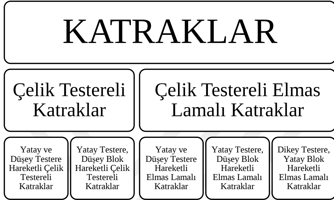
Şekil 6.1 : Katrak blok kesme makine sınıflandırması (T.C. Millî Eğitim Bakanlığı, 2011).
