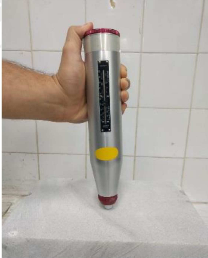
Şekil 7.8 : Schmidt çekici deneyi icra edilmesini gösteren bir fotoğraf
