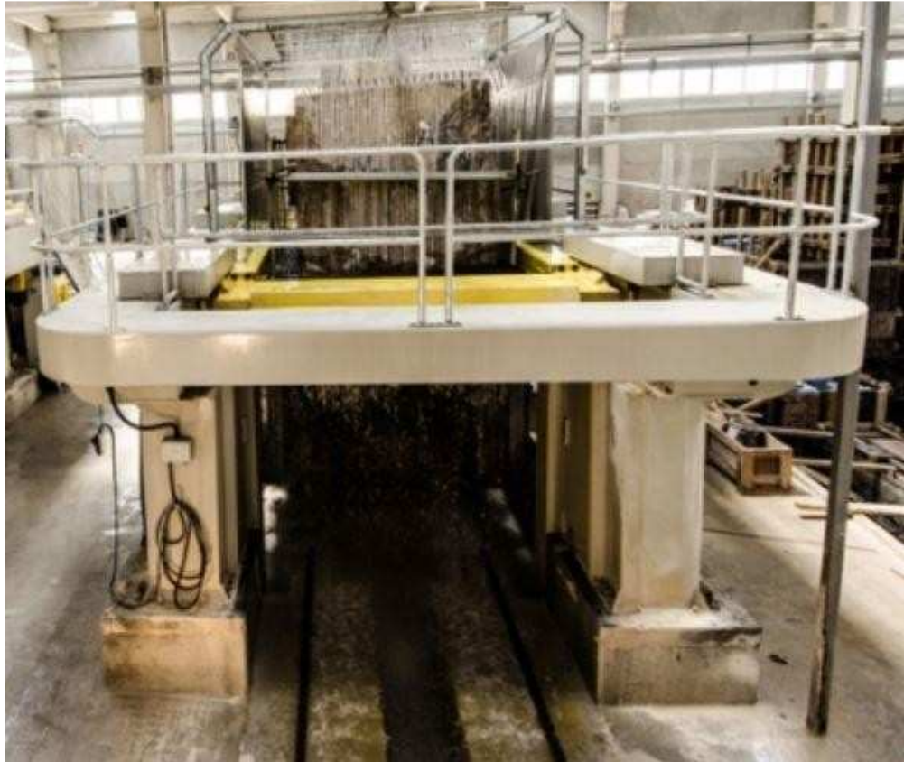
Şekil 8.4 : MKS 80 – 80 lamalı katrak makinesi (MTA, 2020).
