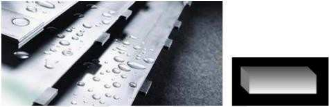
Şekil 6.4 : Katrak lamaları ve elmas soket (T.C. Millî Eğitim Bakanlığı, 2011).
