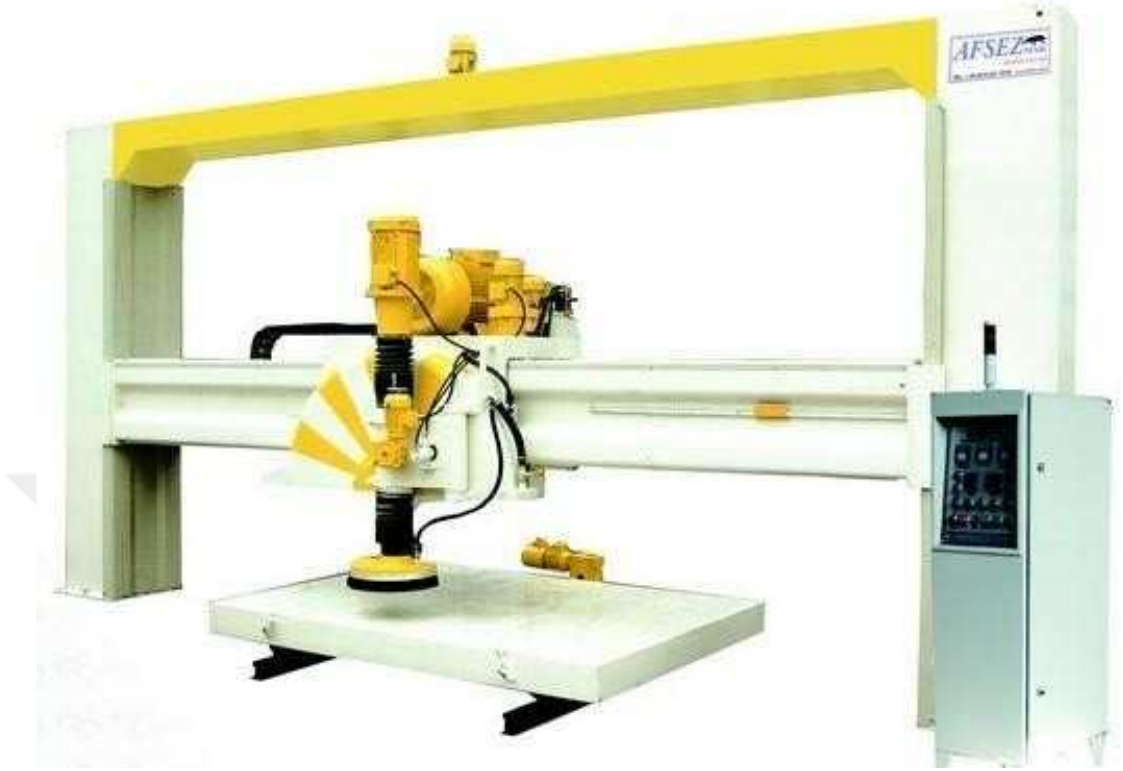
Şekil 4.2 : Ayaklı S/T makinesi (TÜMMER, t.y.)
