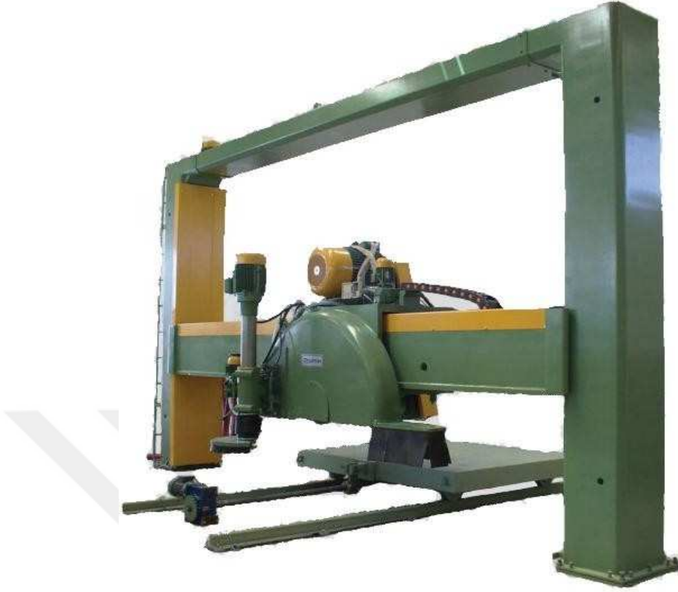
Şekil 5.1 : Çift ayaklı dairesel testereli blok kesme (S/T) makinesi (Gülmas-Gürel Makine Sanayi Kataloğu)
