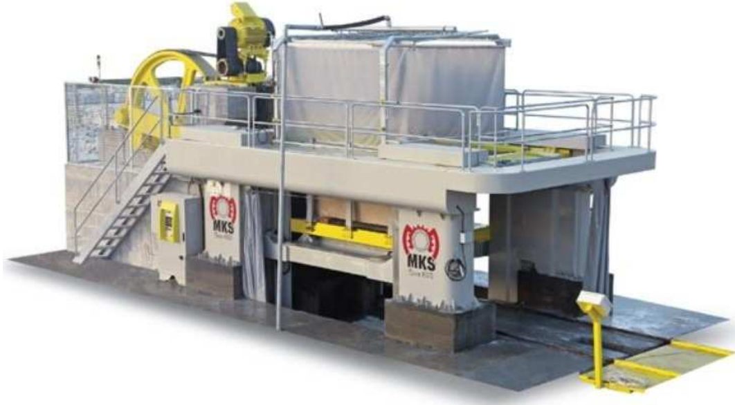
Şekil 4.3 : Katrağ kesme makinesi (MKS, 2023)
