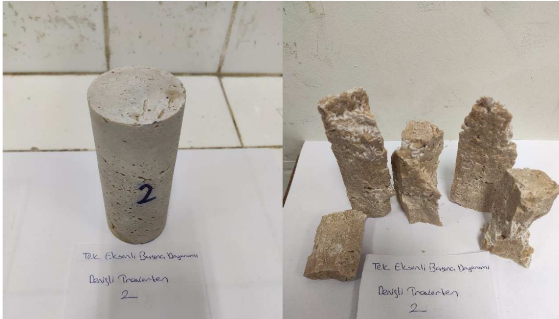
Şekil 7.3 : Denizli traverten tek eksenli basınç dayanımı deneyi öncesi ve sonrası.
