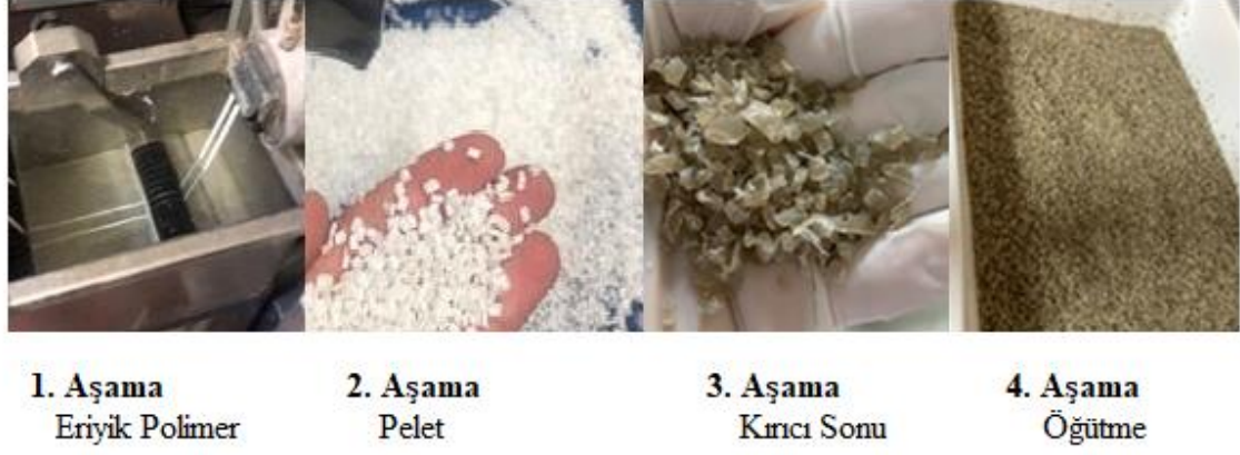
Şekil 3.10. Polimerik malzemelerin öğütülme aşamaları
