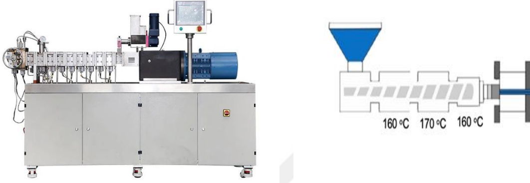
Şekil 4.3. Laboratuvar tipi ekstrüder ve çalışma sıcaklıkları
