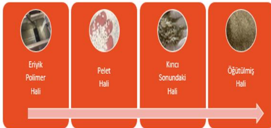
Şekil 4.4. Cips formunda malzeme üretimi
