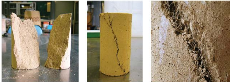
Şekil 2.10 Takviyesiz ve kenevir lifi takviyeli kerpiç (Islam ve Iwashita, 2010)
