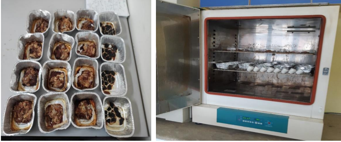
Şekil 16. Balık etlerinin kurutularak sabit tartım ağırlığına getirilmesi (Orijinal).
