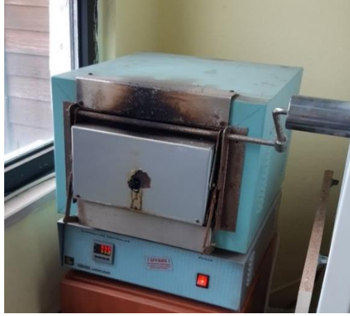
Şekil 19. Balık eti numunlerinin yakıldığı ham kül cihazı (Orijinal).
