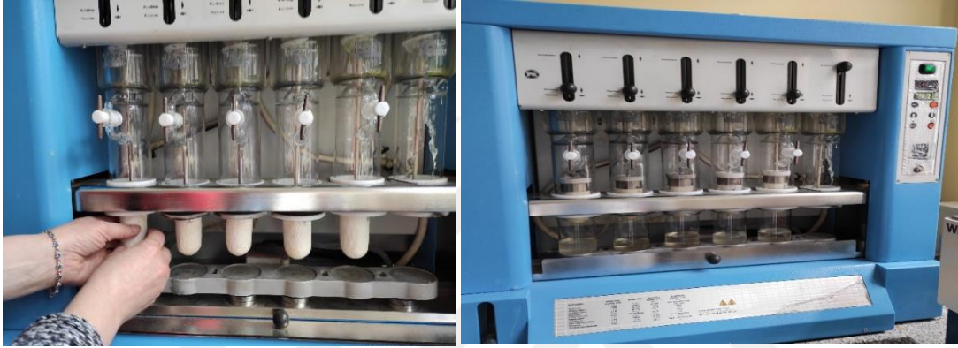
Şekil 18. Ham yağ analizinin yapıldığı Velp SER 148/6 cihazı (Orijinal).
