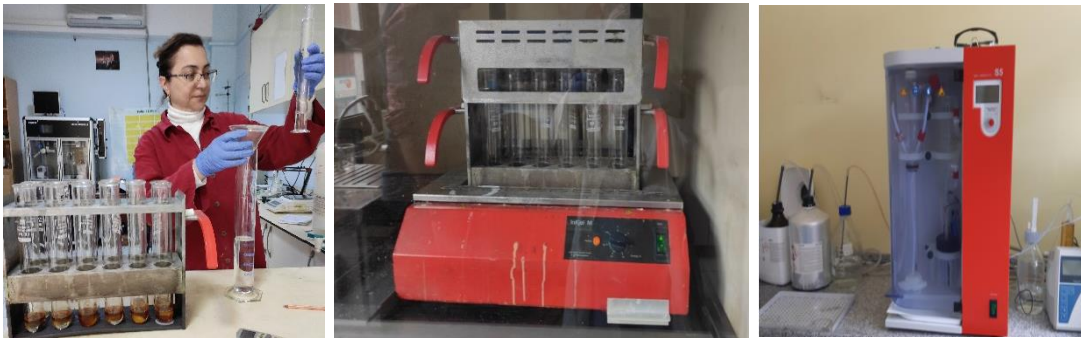
Şekil 17. Ham protein çalışmalarında kullanılan protein tayin cihazları (Orijinal).
