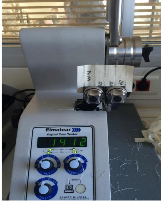
Şekil 2.6. Yırtılma mukavemeti test cihazı ve numune yerleşimi (Kastacı, 2016)
