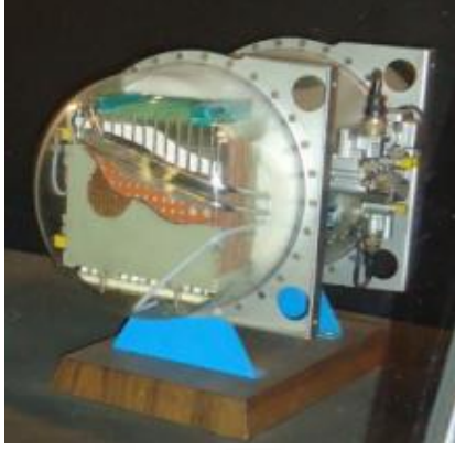
Resim 2.2. Gemini projesinde kullanılan yakıt hücresi [12]
