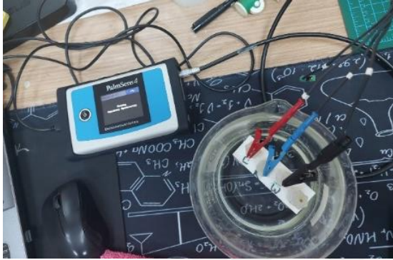
Resim 6.2. Proton iletkenliği ölçüm cihazı
