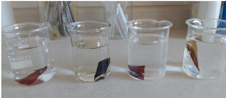
Resim 7.1. Su tutma kapasitesi ölçümü örneği
