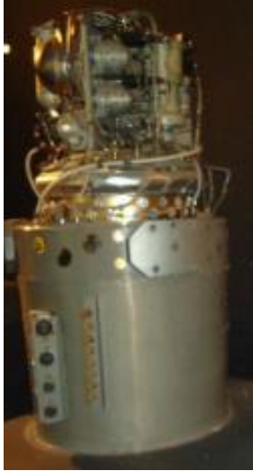
Resim 2.3. Apollo projesinde kullanılan Alkali Yakıt Hücresi [12]
