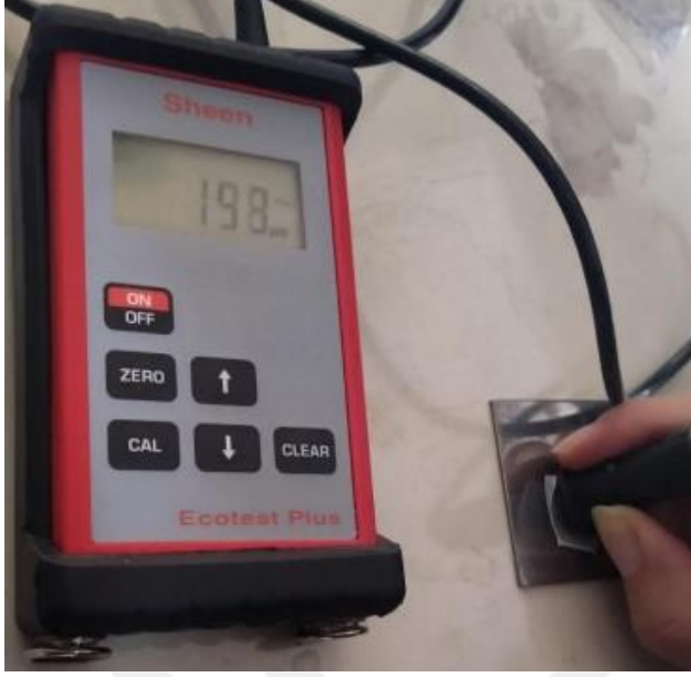
Resim 6.1. Membranların kalınlıklarının ölçülmesi
