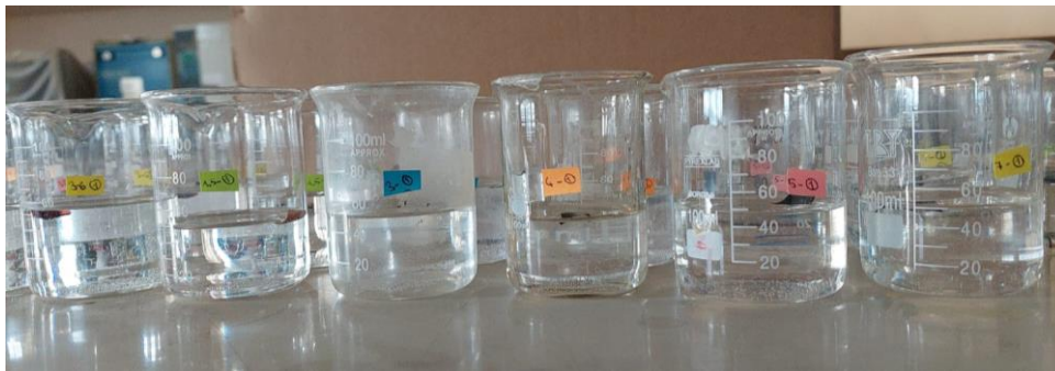
Resim 7.4. İyon değişim kapasitesi hesaplanması için hazırlanan membranlar
