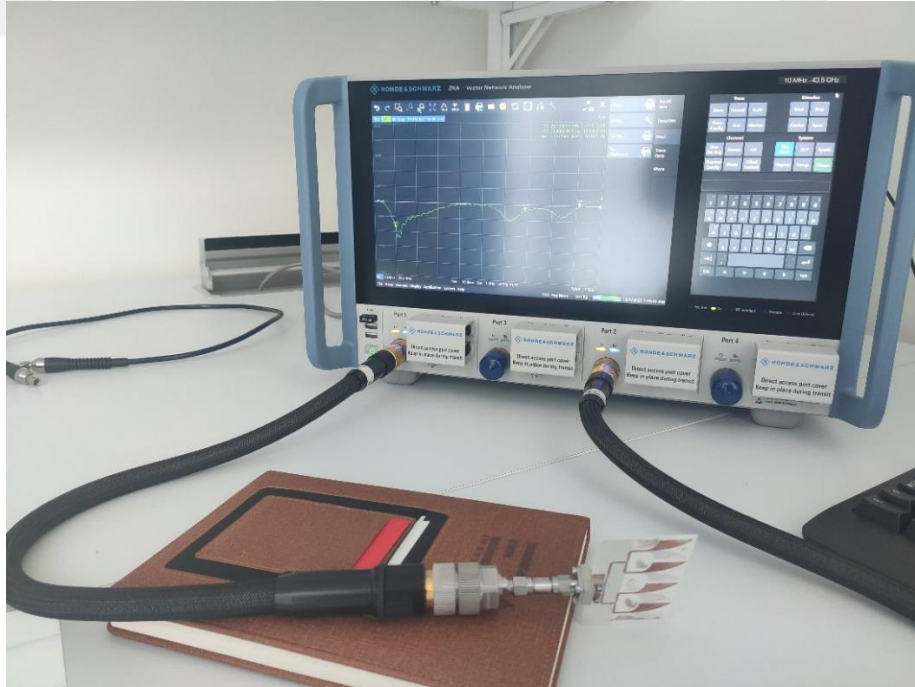
Şekil 5.13 : 1x4 dizi AVA S_{11} test düzeneği.
