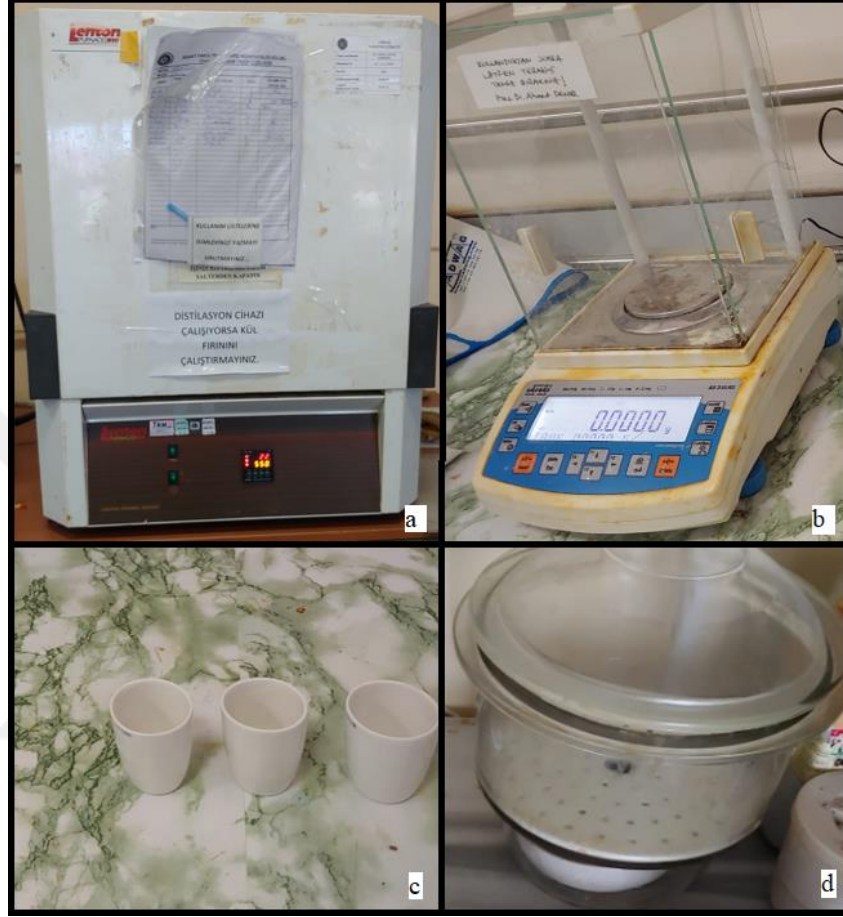
Şekil 3.8 Uçucu katı madde tayini işleminde kullanılan cihaz ve ekipmanlar; (a) kül fırını, (b) hassas terazi, (c) krozeler ve (d) desikatör
