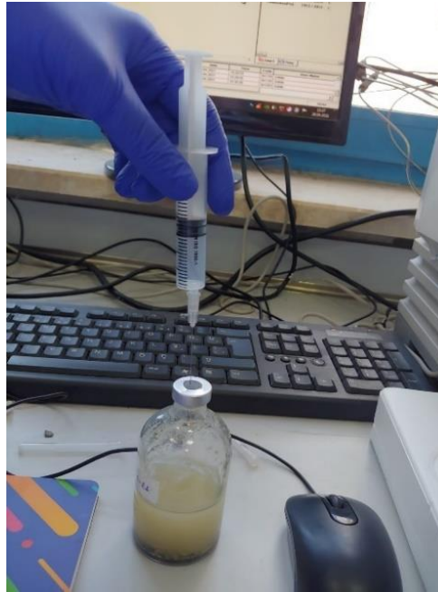
Şekil 3.10 Serum şişelerinde oluşan gazın şırınga ile alınması
