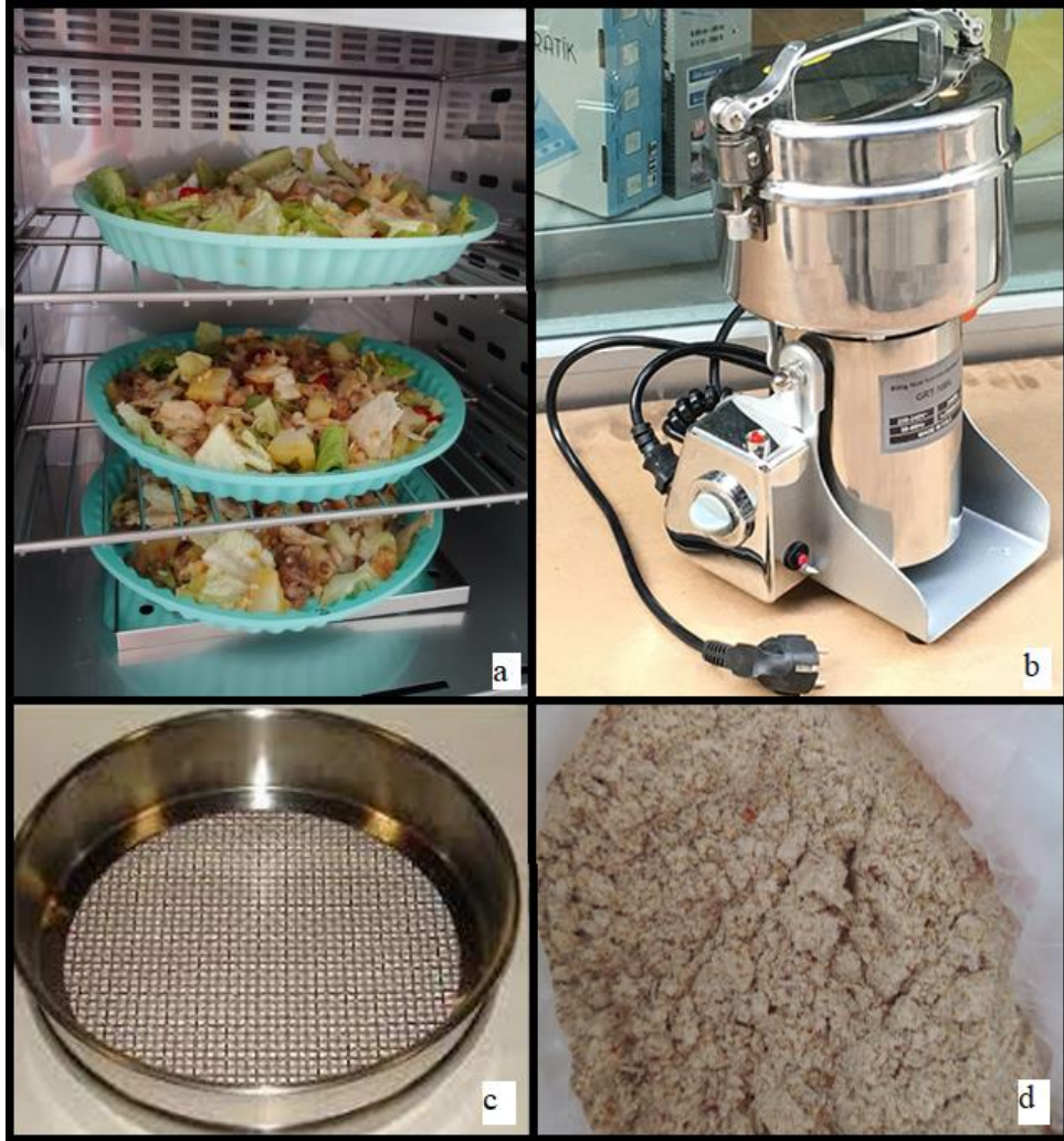
Şekil 3.7 Yiyecek atıklarının ön işlemleri; (a) yiyecek atıklarının kurutulması, (b) deneyde kullanılan öğütücü, (c) 2 mm'lik elek ve (d) elenmiş toz numune
