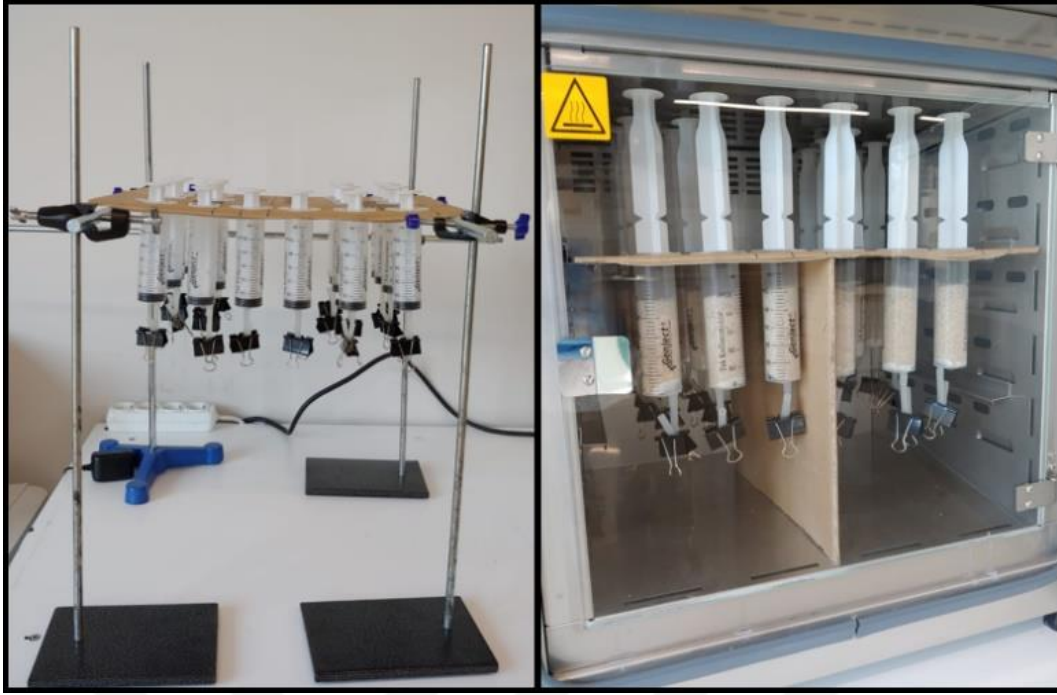
Şekil 3.6 Deney setinin kurulumu ve beslemelerde kullanılan destek ayakları (solda), inkübatöre yerleştirilen deney seti (sağda)
