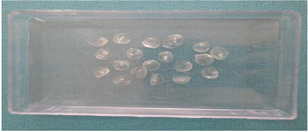
Şekil 3.1 Selülazın PVA jelde immobilizasyonu sonucu oluşturulan jel damlacıkları
