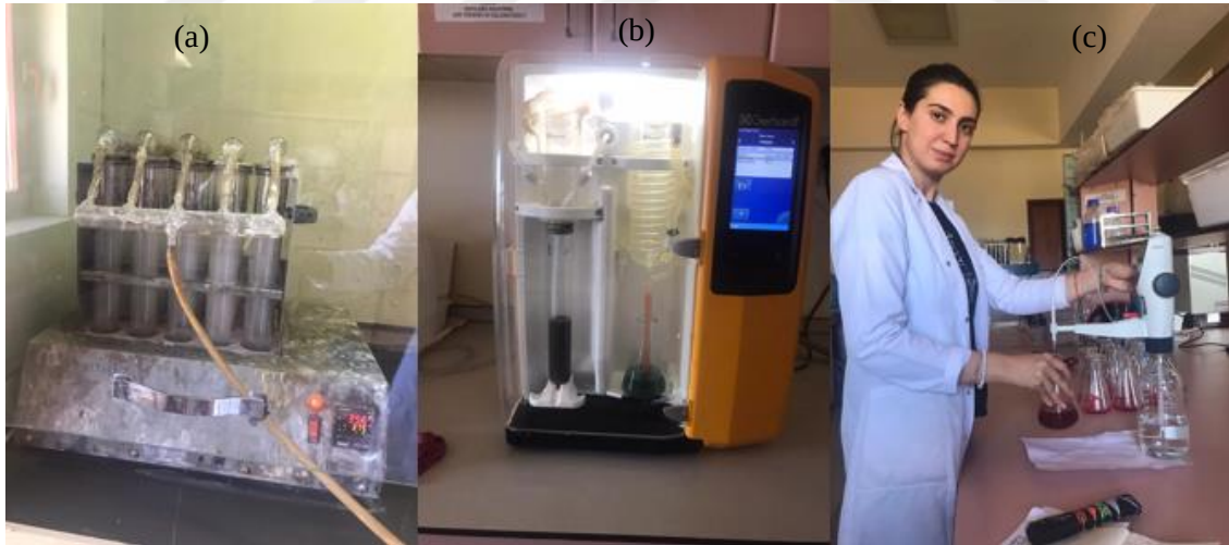
Şekil 3. 11 Modifiye Kjeldahl yöntemine göre azot tayini (a) Yakma ünitesi (b) destilasyon ünitesi (c) titrasyon
