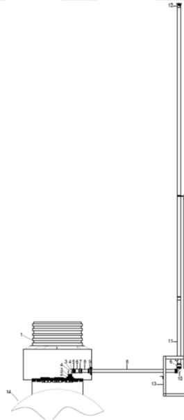
Şekil 4.7 : Tank - nefeslik bağlantı gösterimi (Petrol Ofisi, 2021).
