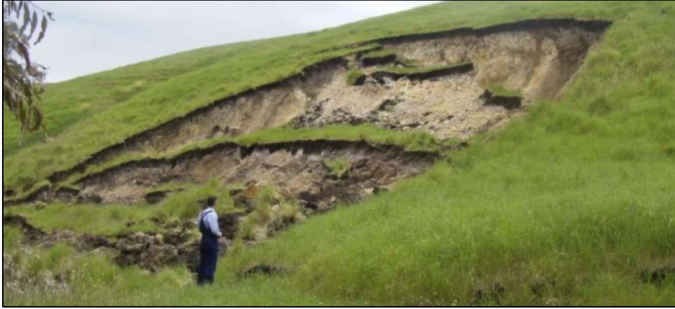
Resim 2.2. Zeminlerde açılmış şevlerde gözlenen dairesel kayma [11]
