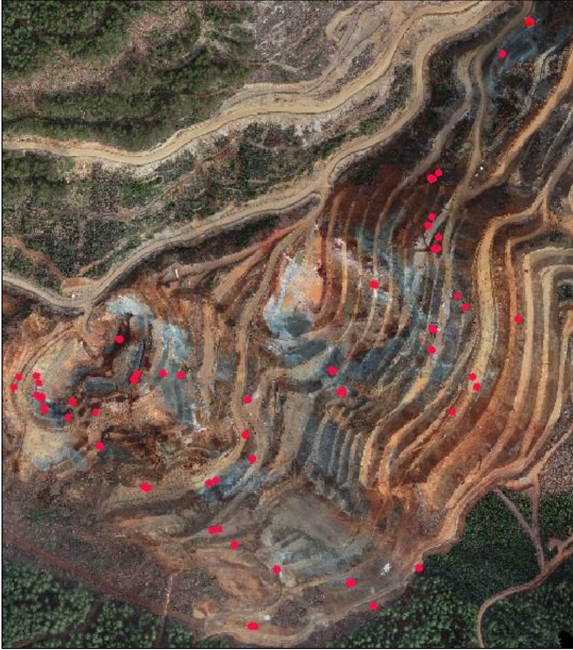
Harita 6.3. Ölçümü yapılan süreksizlikleri gösterir plan (kırmızı noktalar alınan çatlak, foliasyon ve fay yüzeylerine aittir)
