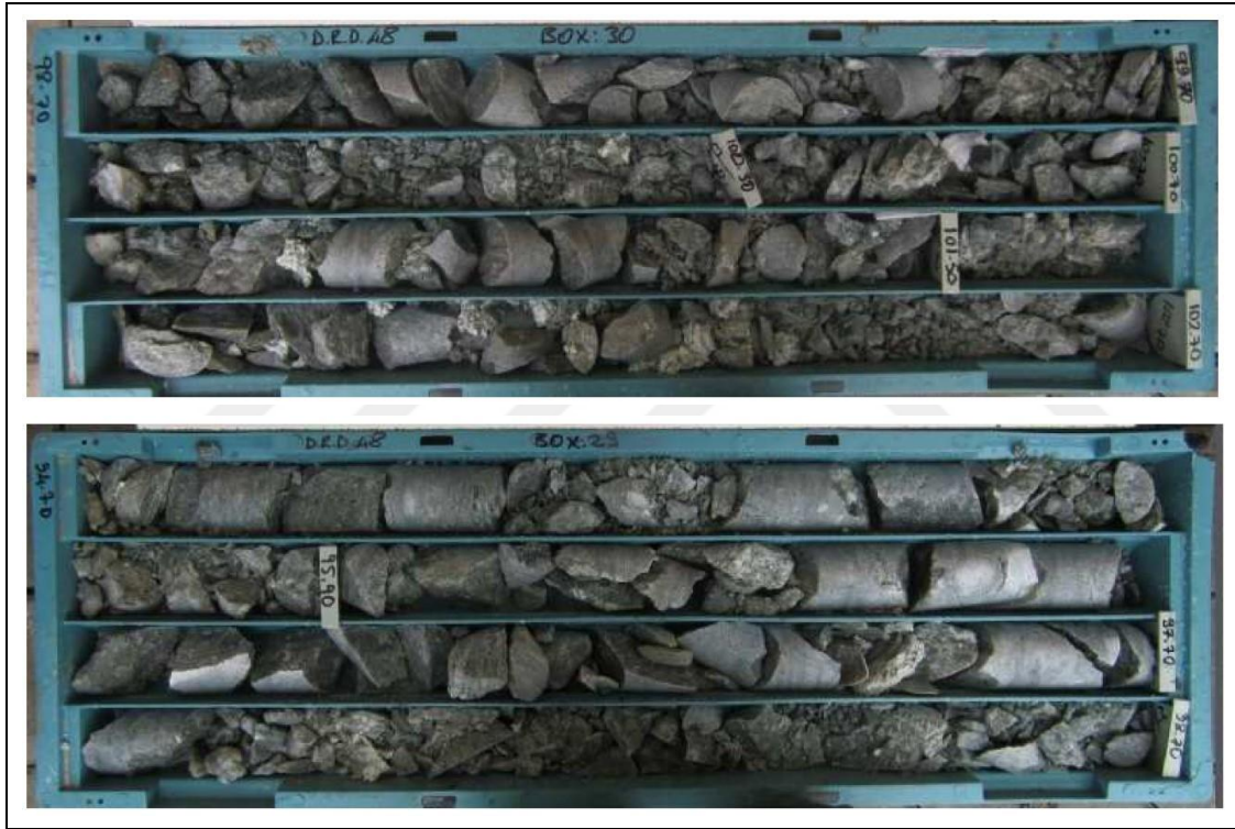
Resim 6.15. Orta ayrılmış kaya kütlmesine ait karot fotoğrafları (1)
