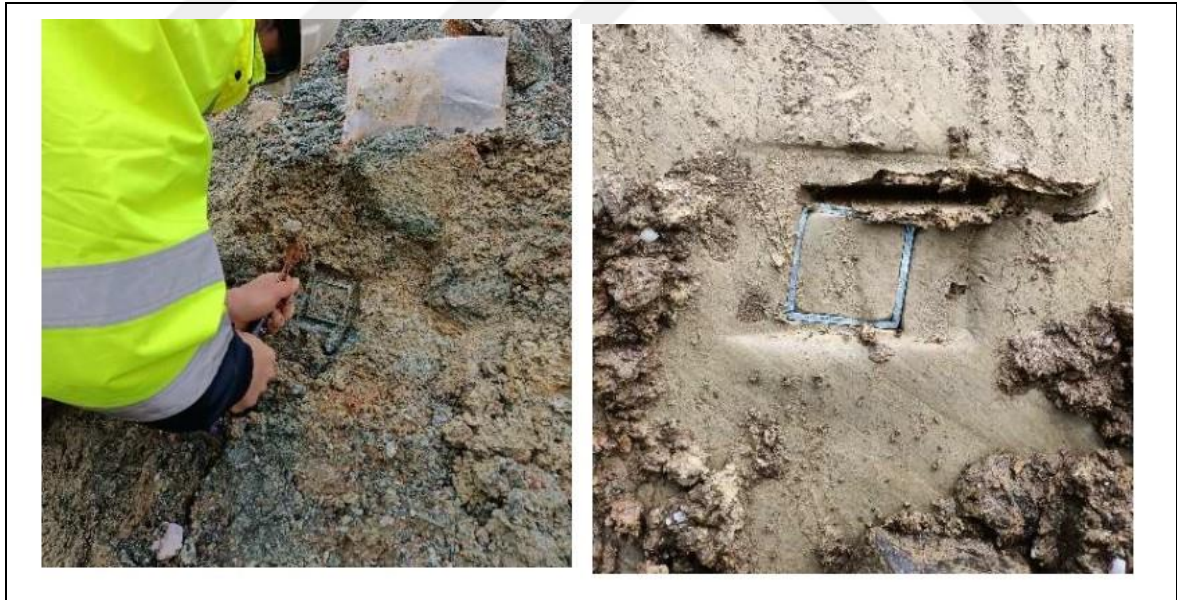
Resim 6.11. Heyelan malzemesine ait örnekler (laboratuvar örneklerinden OO-03 ve OO-04)
