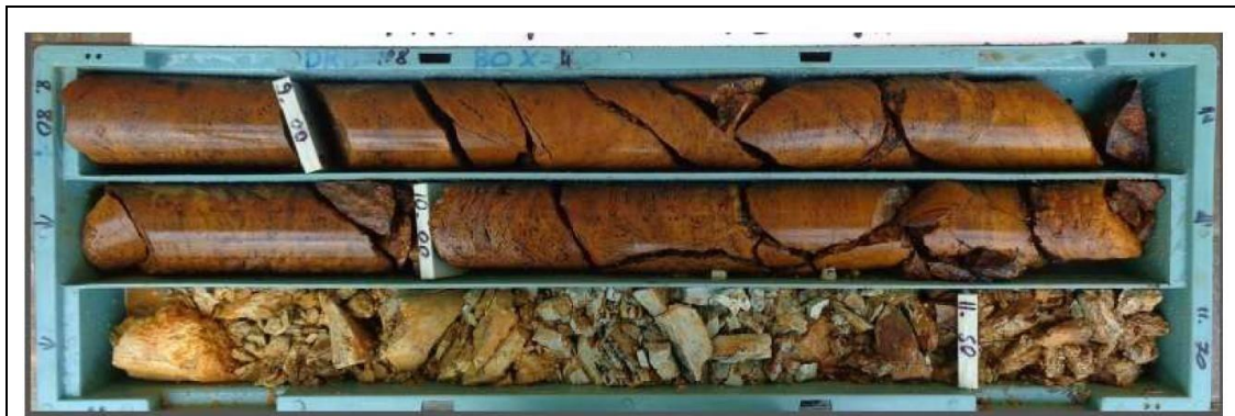
Resim 6.16. Orta ayrılmış kaya kütlmesine ait karot fotoğrafları (2)
