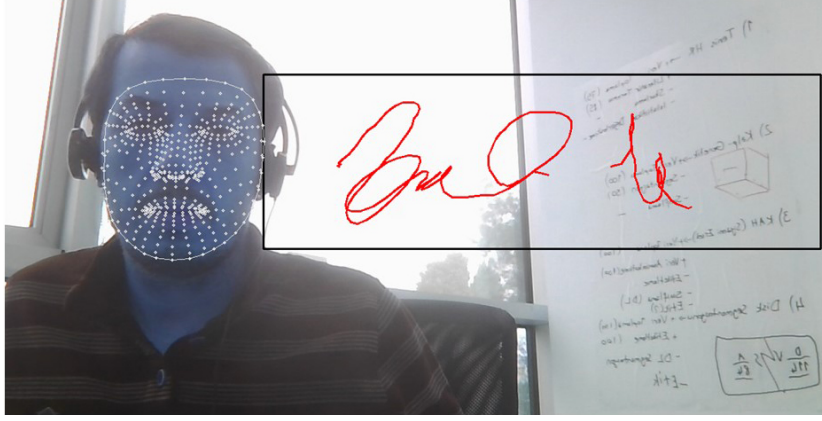
Şekil 4.7 Parçalı olarak atılan bir havada imzanın saklanan sinyalinin bir bölümü. Sinyalin parçalandığı bölge için -1 değerleri yazılmıştır.
