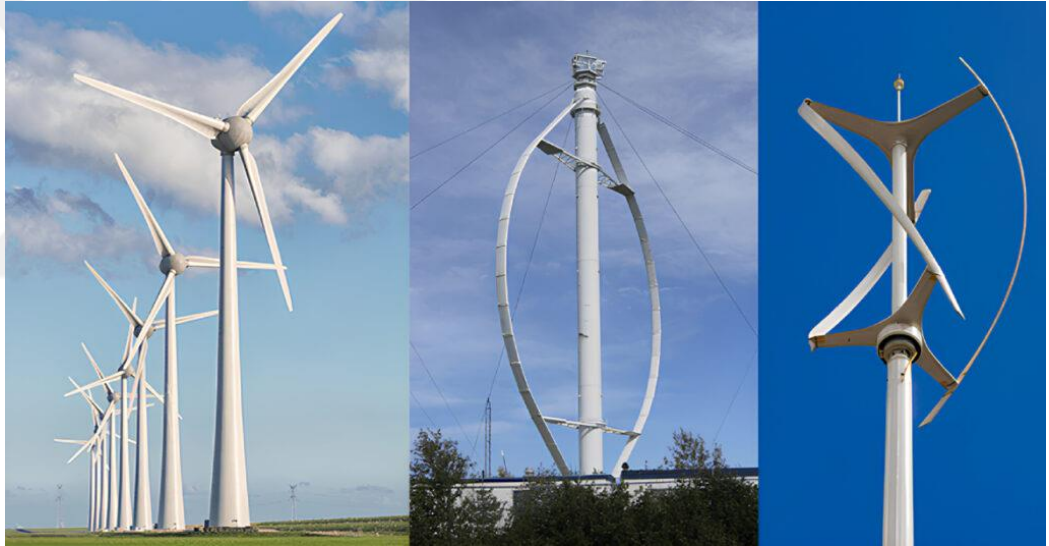
Şekil 10: Yatay Eksenli ve Dikey Eksenli Rüzgar Tribünleri [32]
