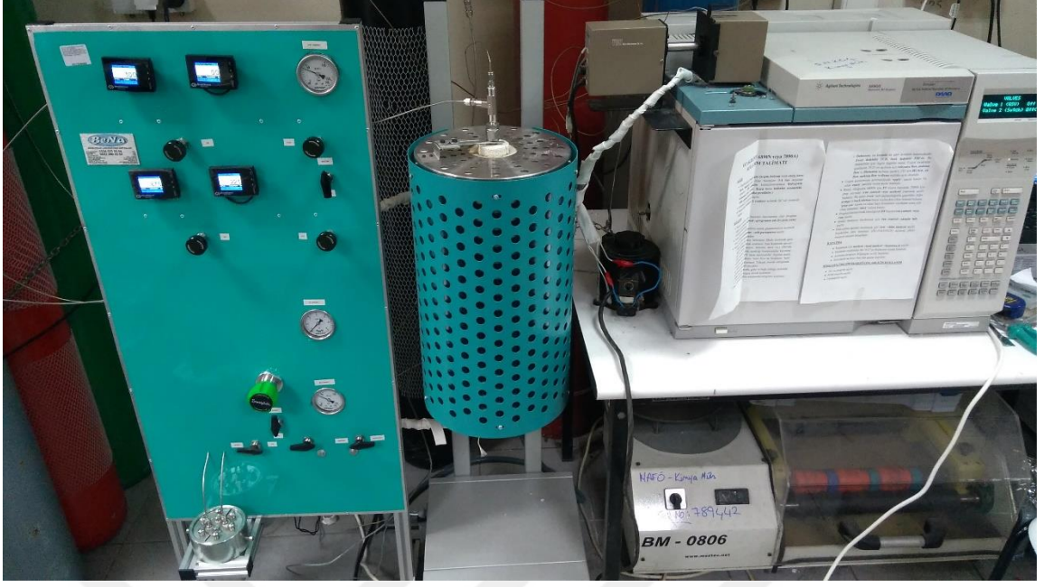
Şekil 3.1. Yüksek basınç piston akışlı katalitik reaksiyon test sistemi-gaz kromatografisi
