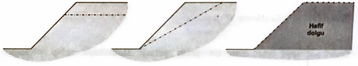
Şekil 14. Yük boşaltma ile şev stabilitesi (Yılmaz, 2007)
