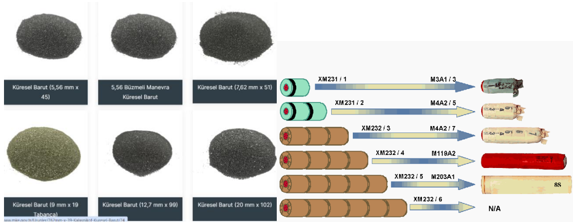
Şekil 3.10. MKE tarafından üretilen barutlar ve bu barutların NATO standardına göre keselenmiş hali [43].
