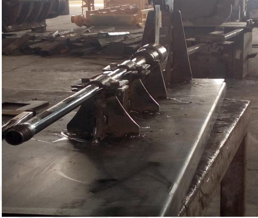
Şekil 5.9. İmalatları tamamlanan deney düzeneği parçalarının montajının yapılması.
