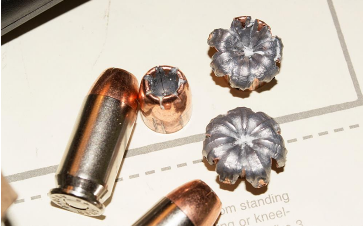
Şekil 3.19. Hedefe atılmış ve hedefte ezilmiş olan tabanca mermileri [50].
