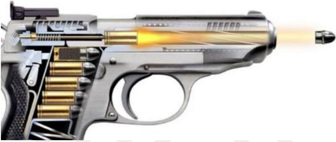
Şekil 3.18. Ateşlenen bir tabancanın kesiti ve merminin, sevk gazlarının hareketlerinin gösterimi [49].
