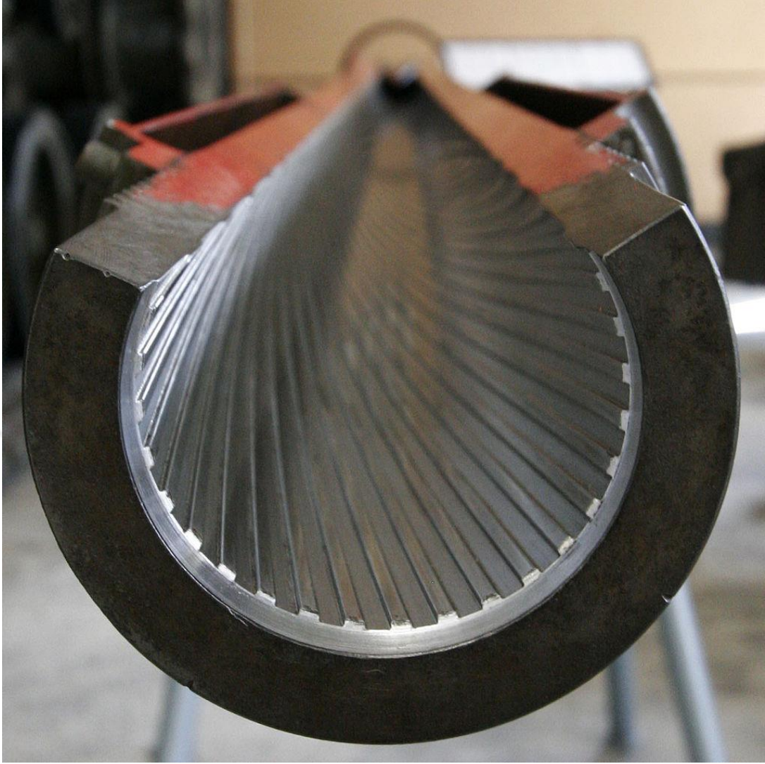
Şekil 3.13. 105mm çapında İngiliz Royal Ordnance L7 tankına ait top namlusuna çekilmiş yiv-setler [45].
