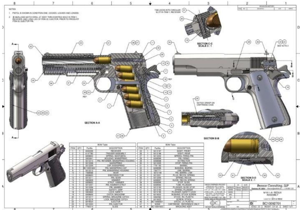
Şekil 3.3. Şarjörle beslenen bir tabancanın kesit görüntüleri [38].
