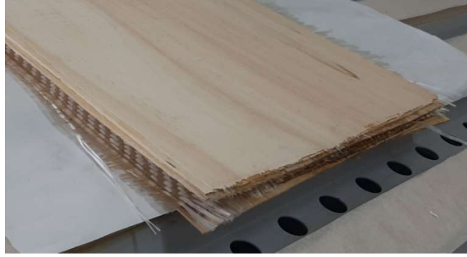
Şekil 3.3. ÜF tutkalı ile üretilmiş ve delamine olmuş panel.
