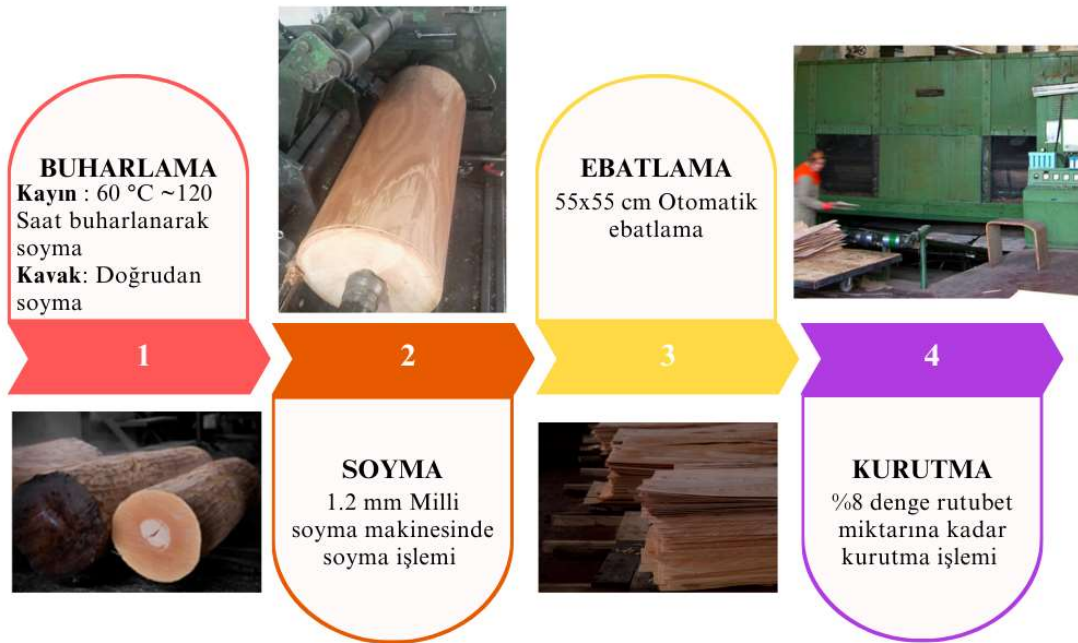
Şekil 3.1. Kaplama üretim aşamaları.
