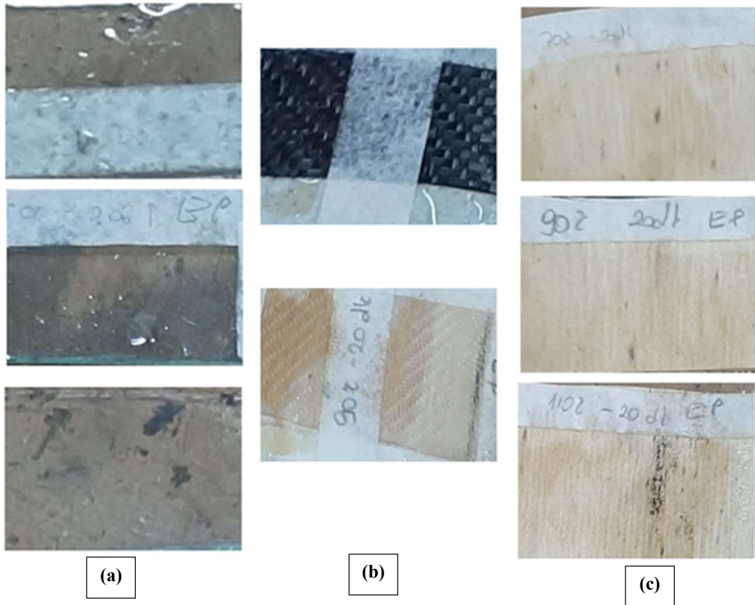
Şekil 3.5. a) Cam lamel üzerine, b) Cam/Karbon elyaf üzerine, c) Kavak kaplama üzerine tutkal uygulama ve fırında kurutma örnekleri.
