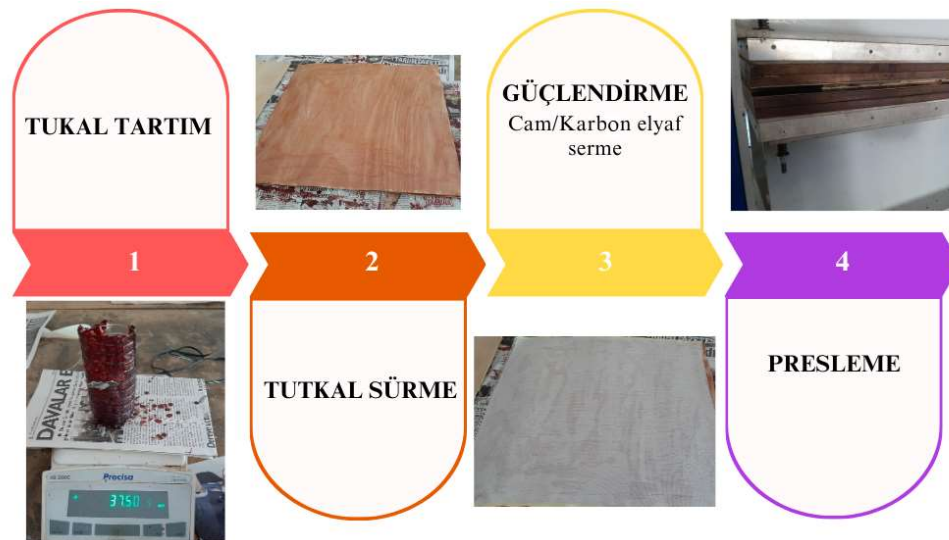
Şekil 3.9. GTAKP Üretim süreci.
