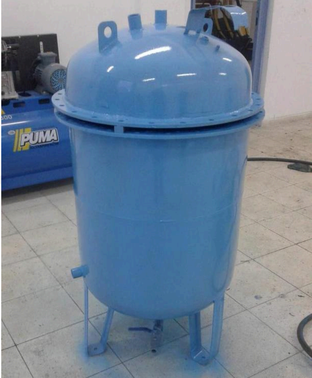
Şekil 3.30. Çalışmada kullanılan absorpsiyon kulesi
