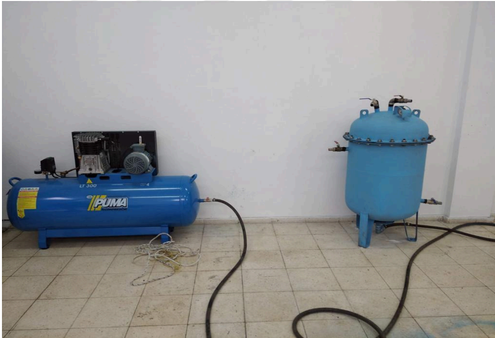
Şekil 3.29. Tez çalışmaları için kurulan water scrubber
