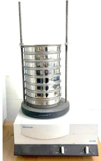
Şekil 3. 8. Titreşimli elek sallayıcı ve farklı delik çaplarına sahip elek serisi
