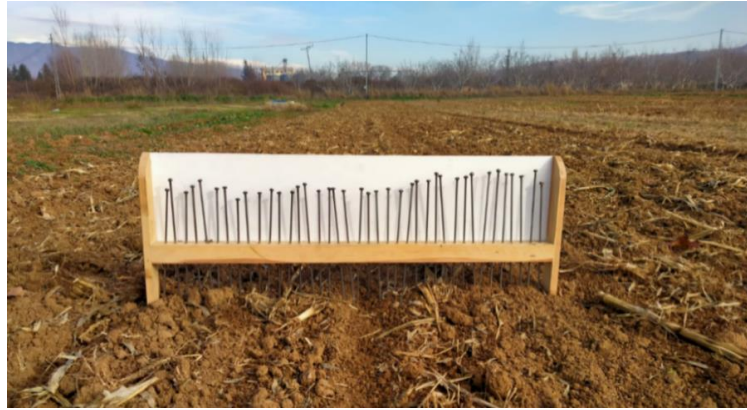
Şekil 3.9. Araştırma alanının yüzey pürüzlülüğünün belirlenmesinde kullanılan profilmetre
