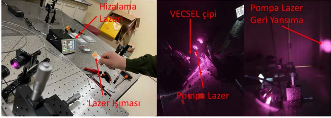
Şekil 5.20 İlk lazer ışınması, pompa lazerin cep telefonu kamerası ile VECSEL üzerine gönderilmesi ve pompa lazerin duvar üzerine geri yansıması (artık pompa).
