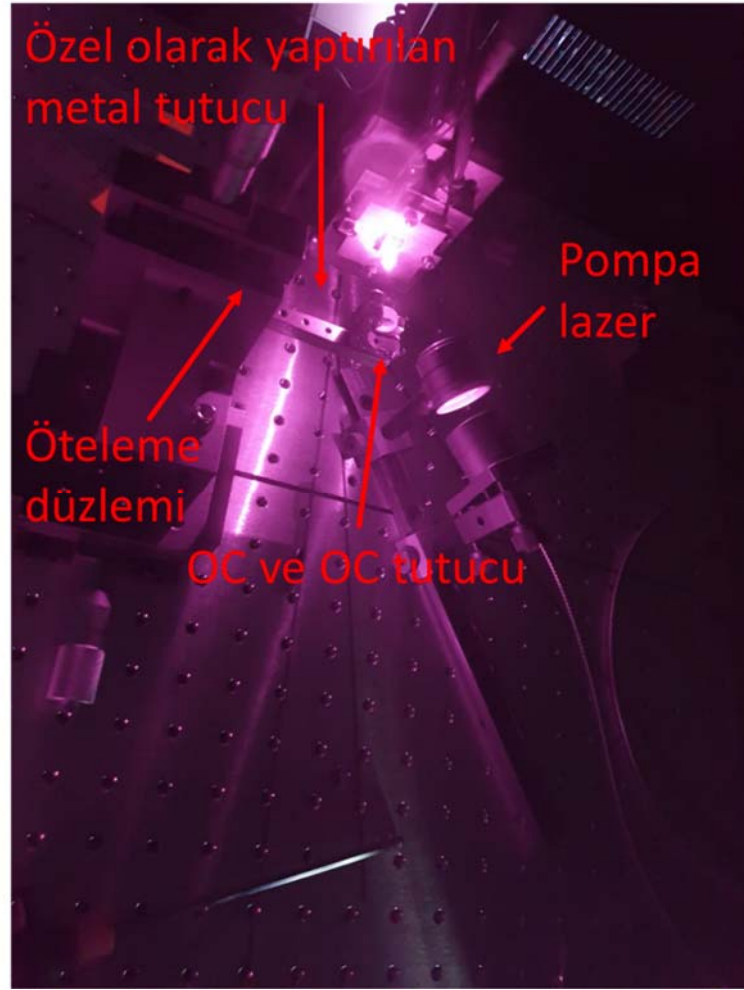
Şekil 5.18 Lazer kavitesi ve optik pompalama anında görünümü
