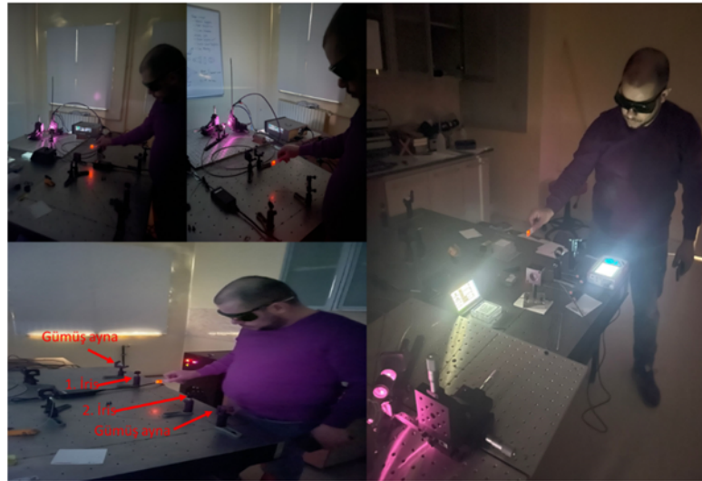
Şekil 5.13 Hizalama lazerinin optik yol boyunca görünümü ve irisler yardımı ile hizalama.
