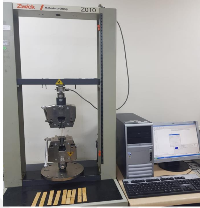
Şekil 3.24. Çekme-makaslama testlerinin gerçekleştirilmesi
