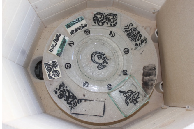
Şekil 26. Macun dekorlu camların gazlı (LPG yakıtlı) fırına yerleştirilmesi
