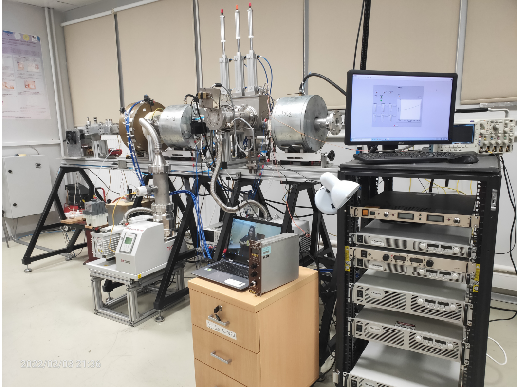
Şekil 4.1 KAHVELab proton hızlandırıcısının iyon kaynağı ve DEDA hattı
