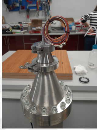
Şekil 3.19 KF25 tipi kör kapaktan el yapımı konnektör
