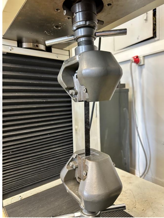
Şekil 2.8 : Test cihazına bağlanmış çekme numunesi.
