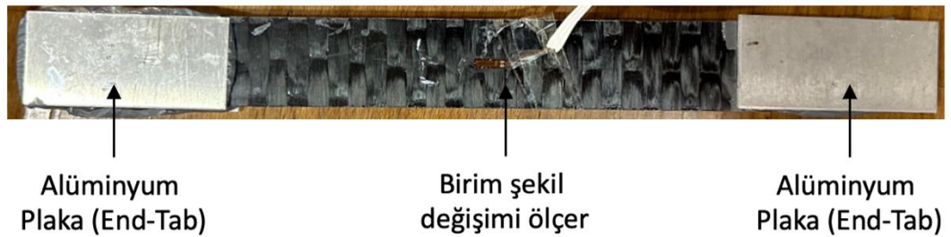
Şekil 2.7 : Teste hazır hale getirilmiş çekme numunesi.
