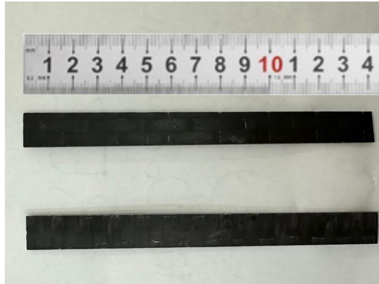
Şekil 2.10 : Basma testine hazır hale getirilmiş numuneler.
