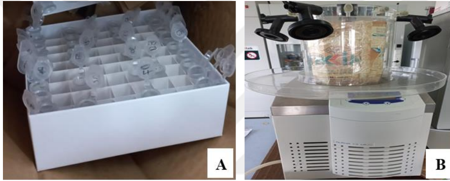
Şekil 3.5. Bitki örneklerinin kurutulmaları A) Bitki örneklerinin kurutulmak üzere hazırlanarak stok kutularına yerleştirilmeleri B) Örneklerin vakum atmosferi altında dondurularak kurutuldukları liyofilizatör cihazı
