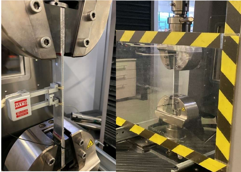
Şekil 5.1. Çekme testinin gerçekleştirilmesi
