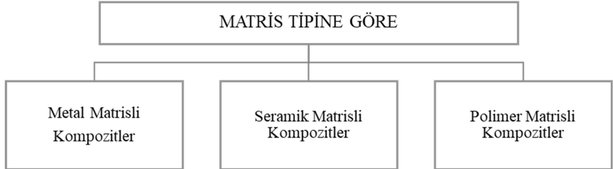
Şekil 2.4. Matris tipine göre kompozit malzemelerin sınıflandırılması
