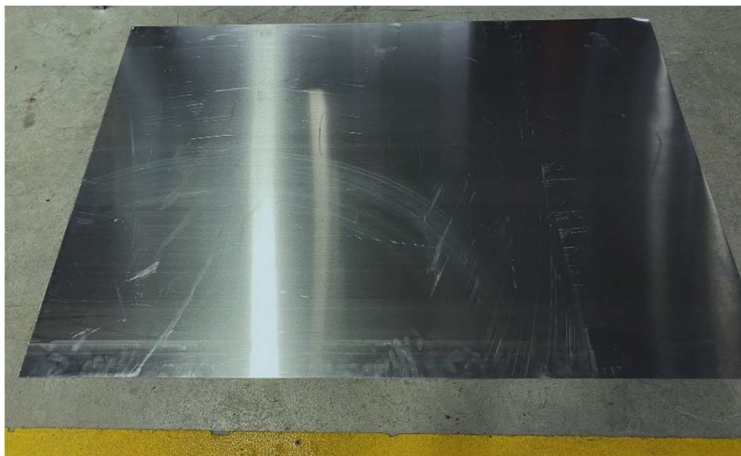
Şekil 4.2. AZ31B Magnezyum Alaşımı
