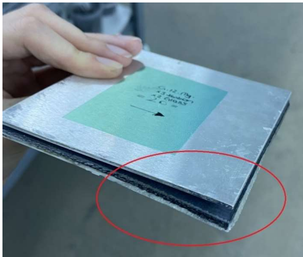
Şekil 4.18. Ayrılma görülen G12 test plakası
