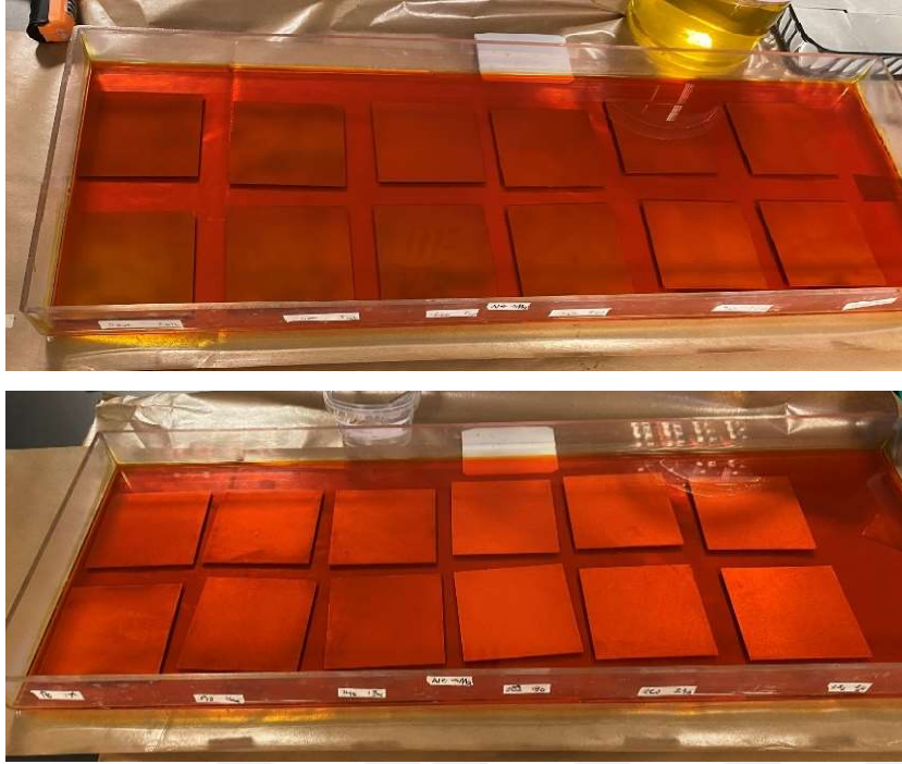
Şekil 4.11. Kromik asit çözeltisinde bekletilen test plakaları
