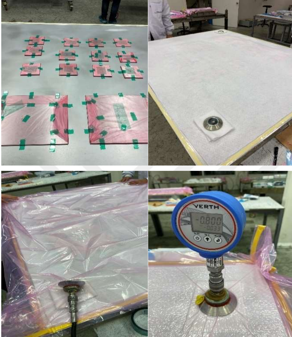
Şekil 4.16. Vakum torbalama işlemleri
