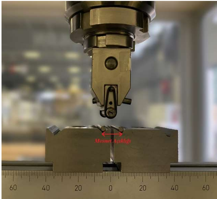
Şekil 5.2. ILSS testlerinin gerçekleştirilmesi
