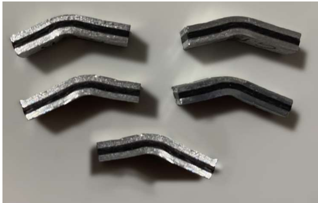
Şekil 6.8. ILSS testi sonrası 1050 Al ile üretilen FML kompozitler
