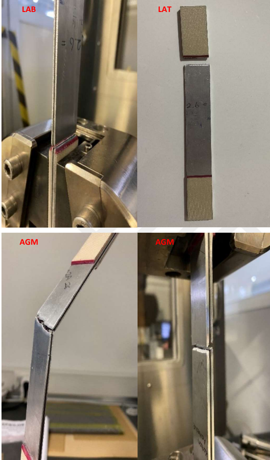
Şekil 6.6. Numunelerin kırılma tipleri
