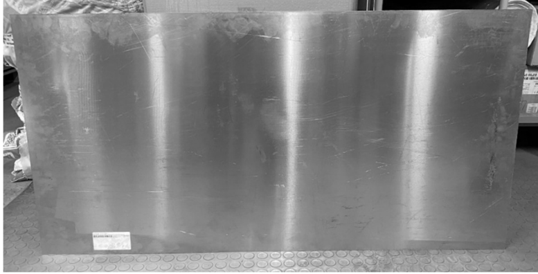
Şekil 4.1. 1050 Alüminyum test plakalarının kesildiği levha
