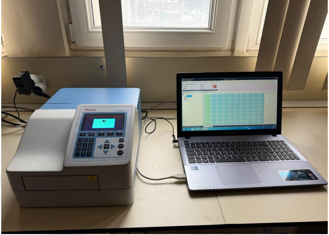
Şekil 3.2. Microplate okuyucu ile 450 nm’de okutuldu
