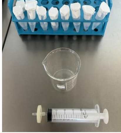
Fotoğraf 3.4. Steril selüloz asetat filtreden geçirilerek eppendorflara yerleştirilen alendronat sodyum trihidrat solüsyonları
