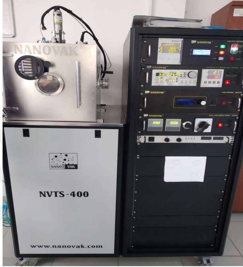
Şekil 27. Termal buharlaştırma ile ince film kaplama ve manyetik alanda DC saçırma ünitesi, NANOVAK NVTS-400
