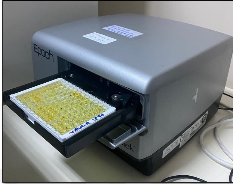
Şekil 18. Biotek Epoch Microplate Spectrophotometer ELISA okuyucu cihazına plakanın yerleştirilmesi
