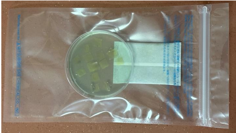
Şekil 7. Grup 4’te Kullanılacak Silikon Materyallerin Anaerobik Koşullarda Cutibacterium acnes ile Kontaminasyonu
