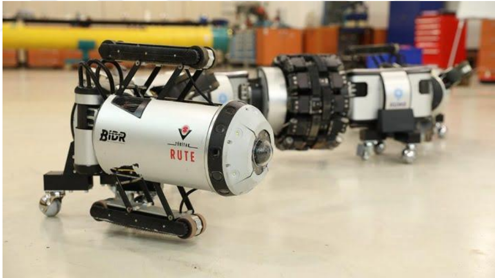
Şekil 3.8. TÜBİTAK tarafından geliştirilen boru içi denetim robotu [12].
