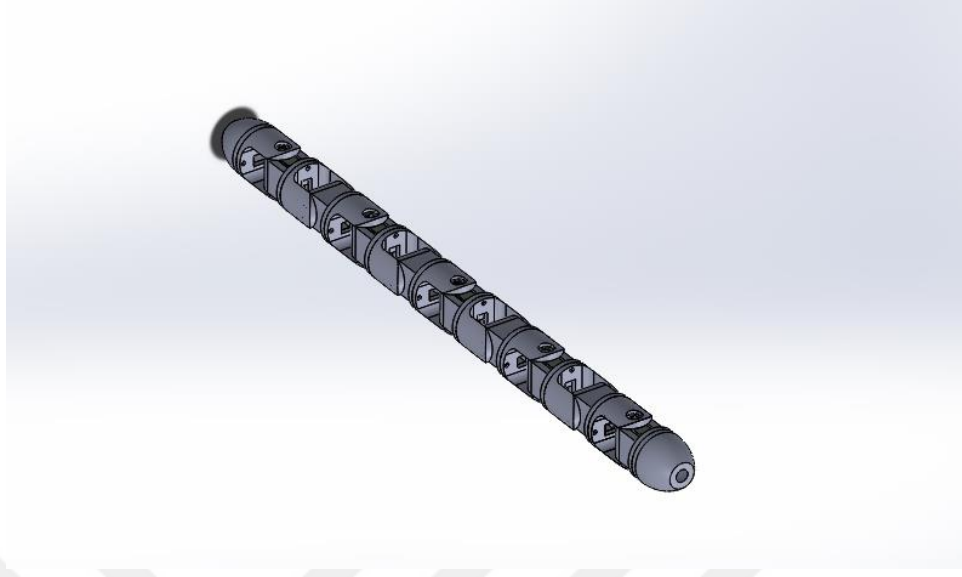
Şekil 4.4. İlk olarak kare formunda tasarlanan yılan robot.
