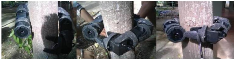
Şekil 3.7. Askeri gözlem ve keşif amaçlı yapılan yılan robot [29].
